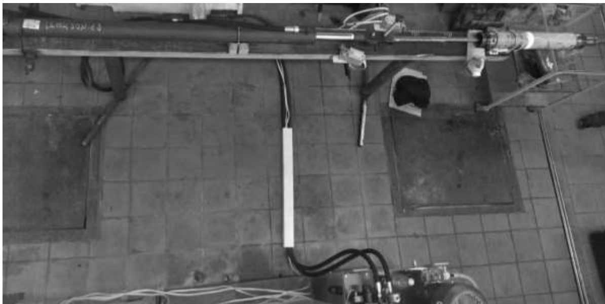
Рисунок 5. Фотография стенда в процессе испытаний магетного образца узла уплотнения
