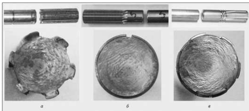
Рисунок 2. Характер разрушения валов с различными шлицевыми соединениями: а – с прямобочными, б – с эвольвентным, в – с прямобочным низкопрофильным
