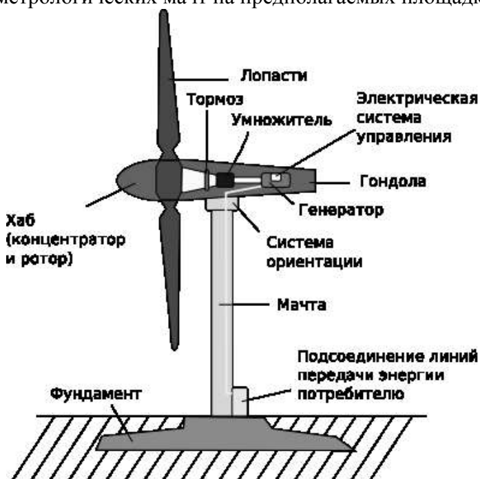
Рисунок 3. Схема устройства ветрогенератора
