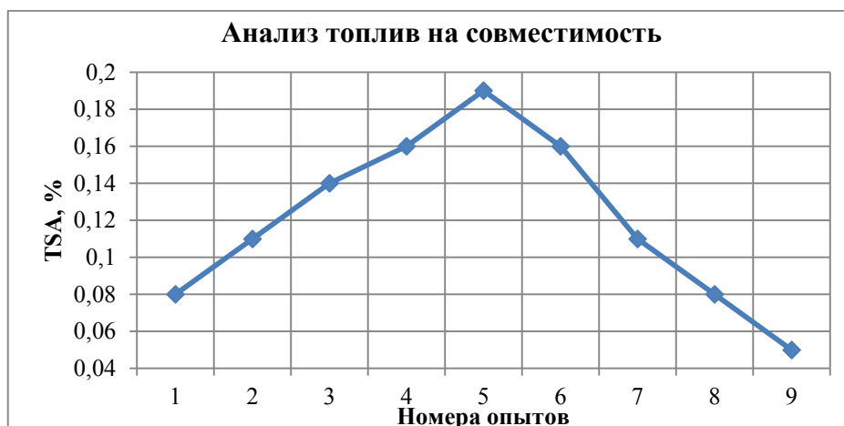
Рисунок 2. Анализ нефтепродуктов на совместимость с разными соотношениями компонентов
