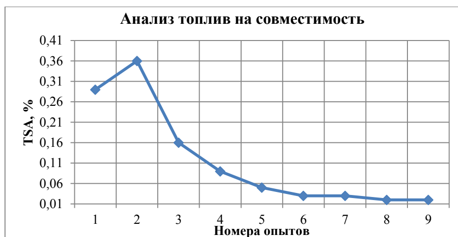
Рисунок 3. Анализ нефтепродуктов на совместимость с разными соотношениями компонентов
