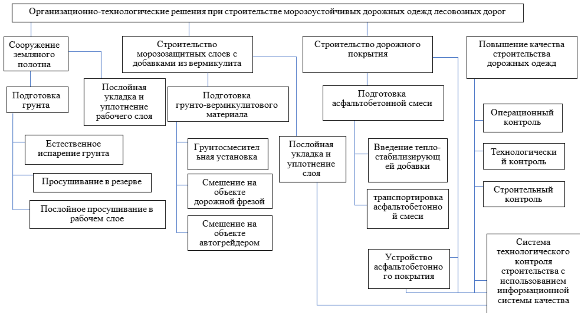
Рисунок 1 – Организационно-технологические решения при строительстве морозоустойчивых дорожных одежд лесовозных дорог
