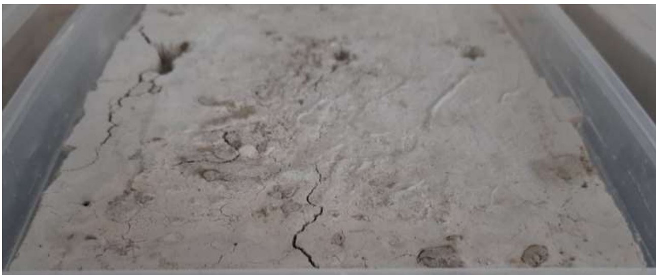
Рисунок 1 – Эксперимент по влиянию прогрева бетона на трещинообразование
