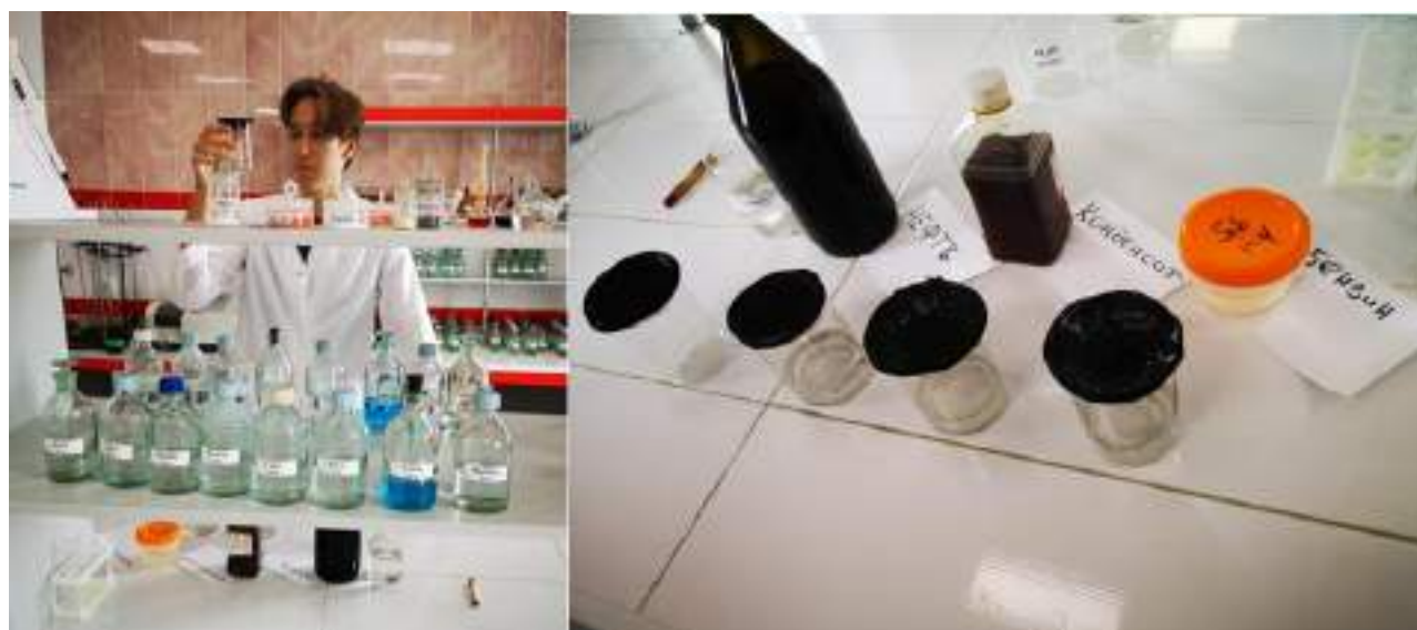
Рисунок 2. Испытания на гидрофобность и липофобность
