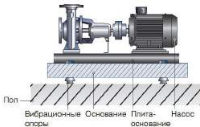
Рисунок 1 – Активная виброзащита фундамента магистрального насосного агрегата
