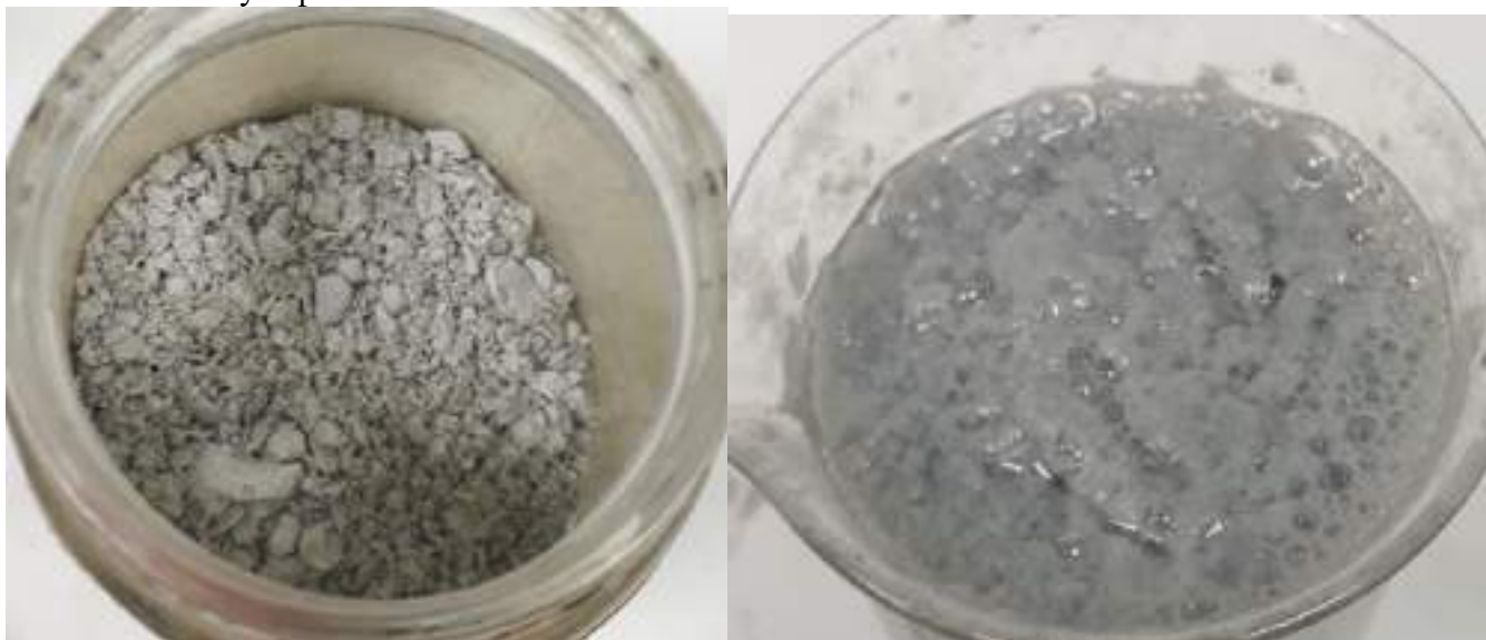
Рисунок 2 – Асбестовая крошка - не модифицированный асбест, КАЗ – модифицированный асбест (слева направо)
