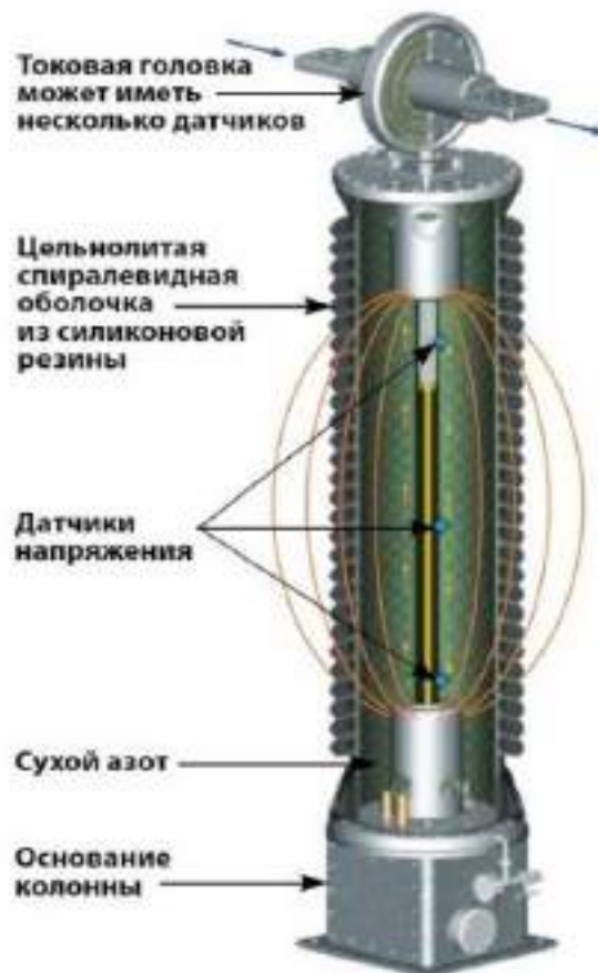
Рис. 2 – Устройство оптического трансформатора напряжения (ОТН)
