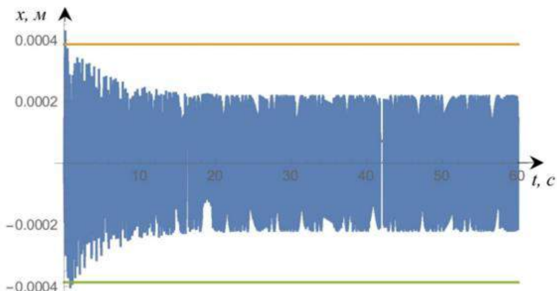
б) Волновая диаграмма виброскорости при пуске МНА, с использованием демпфирующего материала
