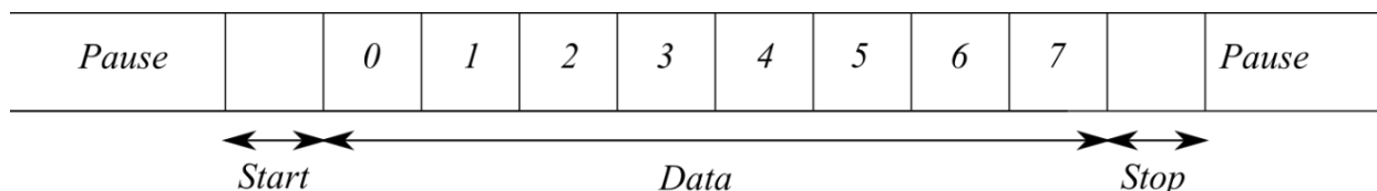
Рисунок 2 – Временная диаграмма передачи данных протокола UART
