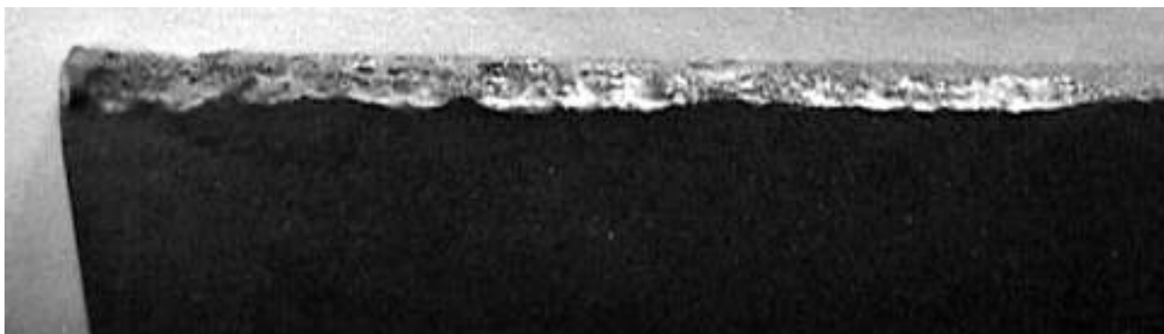
Рисунок 5 – Ван-Еганское месторождение, трубопровод \text{Ø}219 \times 11 мм, эмульсионный режим течения (газ, нефть, вода, газ), дебит жидкости 1100 – 1400 м 3 /сут., обводненность 70 – 80%. Внешний вид торцевой поверхности ОКК с локальной коррозией после ОПИ ИК Корексит SXT 1002, экспозиция 63 сут. Защитный эффект по КР – 93,2%, защитный эффект по скорости ЛК отсутствует.
