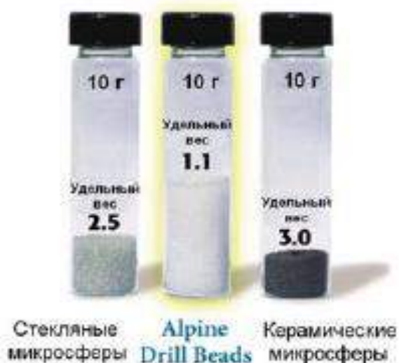
Рисунок 2 - Сравнение стеклянных микросфер, керамических микросфер и «ALPINE DRILL BEADS»
