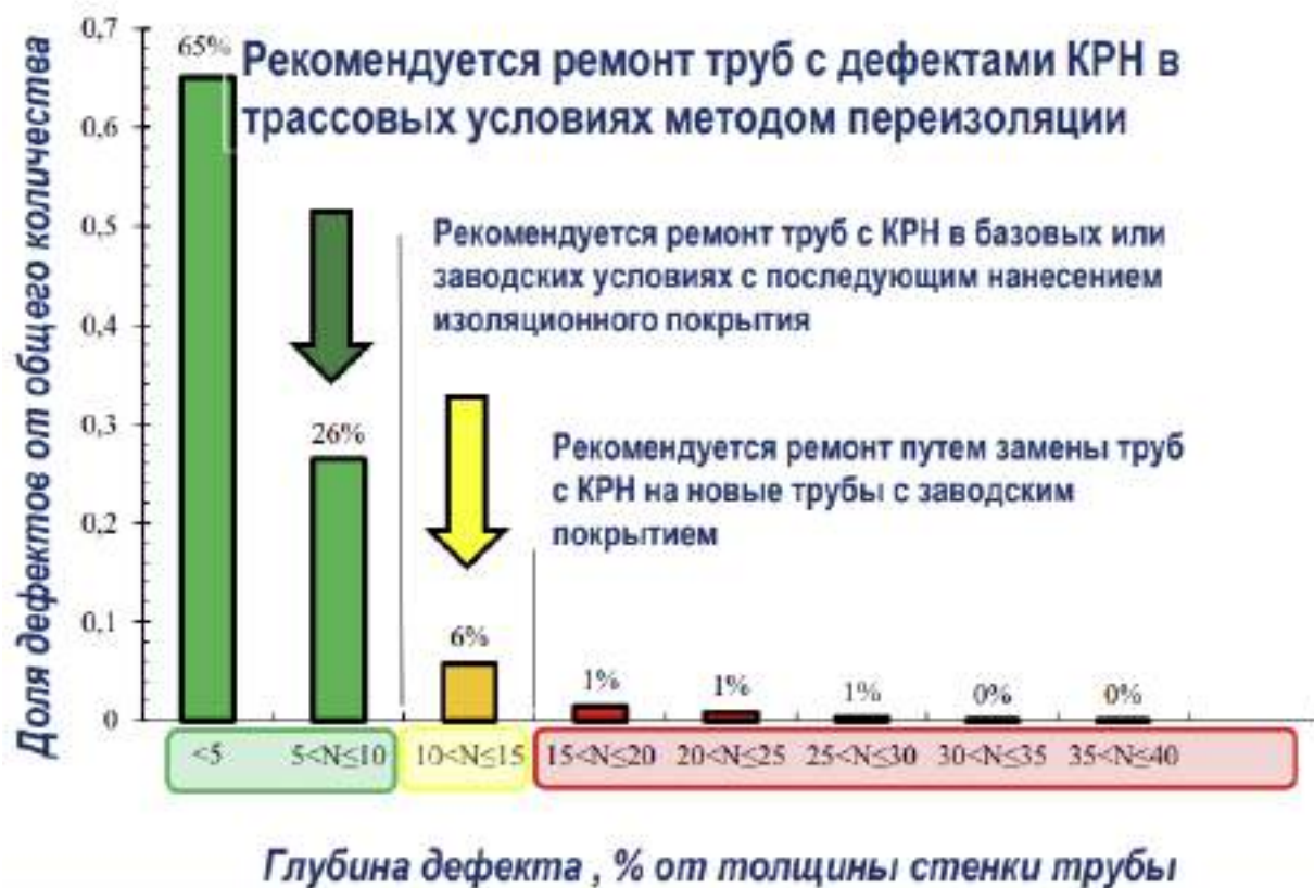
Рисунок 3 – Распределение дефектов, образованных по механизму КРН
