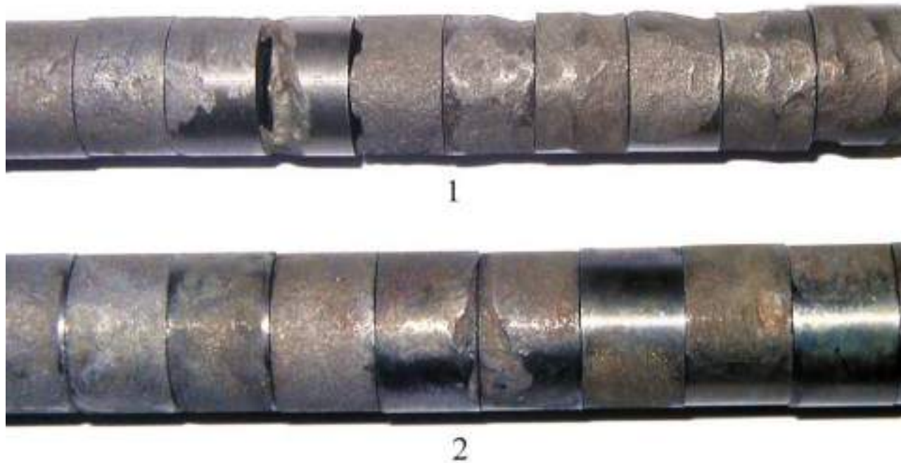
Рисунок 6 – Внешний вид ОКК при ОПИ ИК KW-2593: 1 – при измерениях контрольной скорости коррозии (77 сут.); 2 – при дозировании KW-2593 (27 сут.). Защитный эффект по КР – 70,6 \% , защитный эффект по скорости ЛК отсутствует
