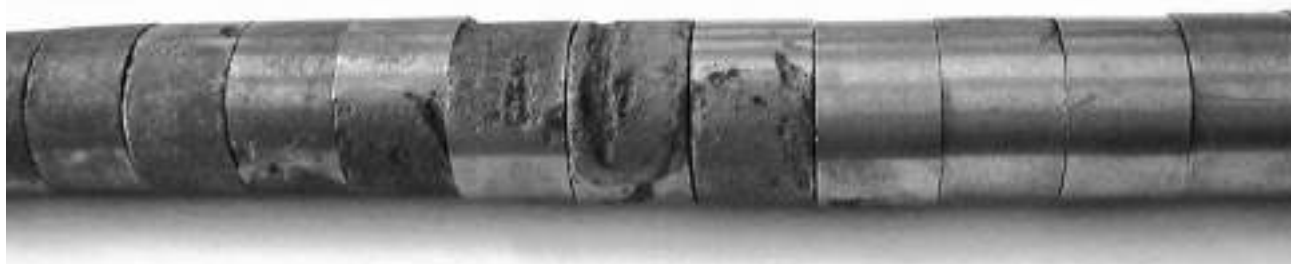
Рисунок 7 – Внешний вид ОКК при промышленном применении ИК Dodicor V 4712
