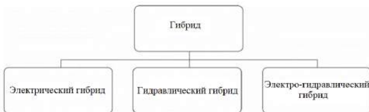
Рисунок 1 – Классификация гибридных приводов
