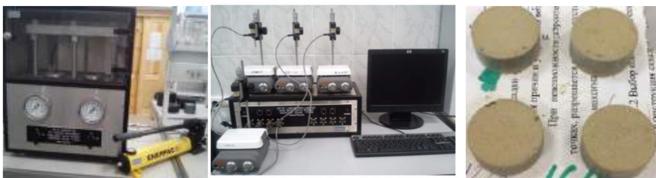
Рисунок 3 - Тестер продольного набухания производства OFITE, компактор производства OFITE, глинопесчаные образцы (слева направо)
