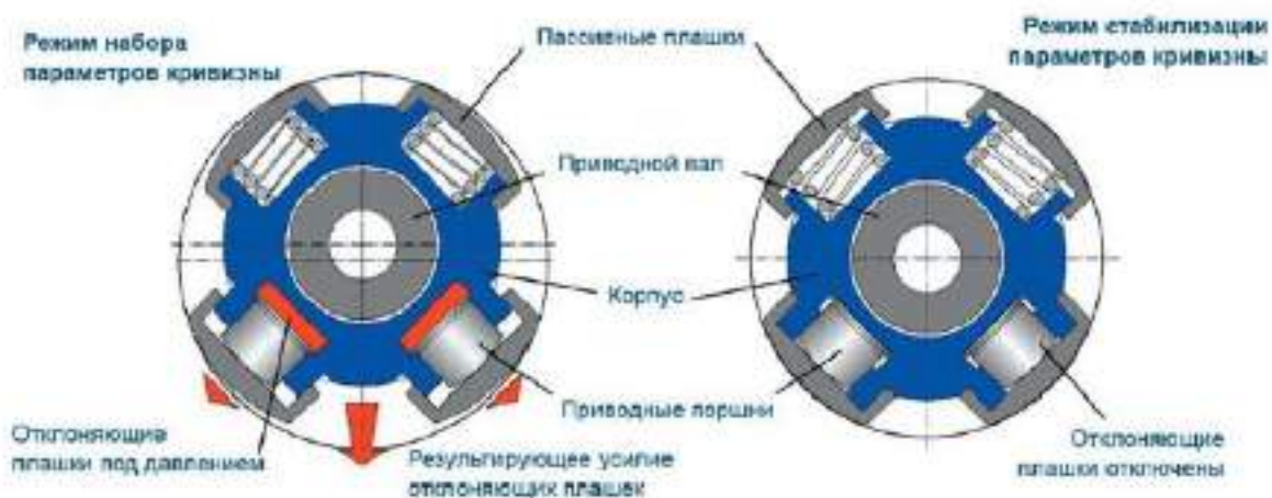
Рисунок 2 – Расположение плашек в блоке отклонения
