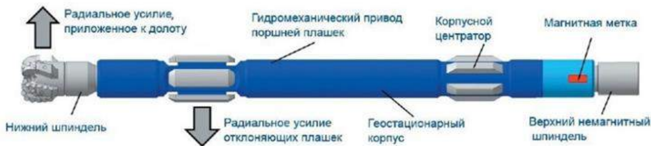
Рисунок 1 – Общая схема РУС-ГМ
