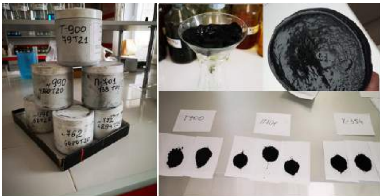
Рисунок 1. Создание образцов криогеля с техуглеродом
