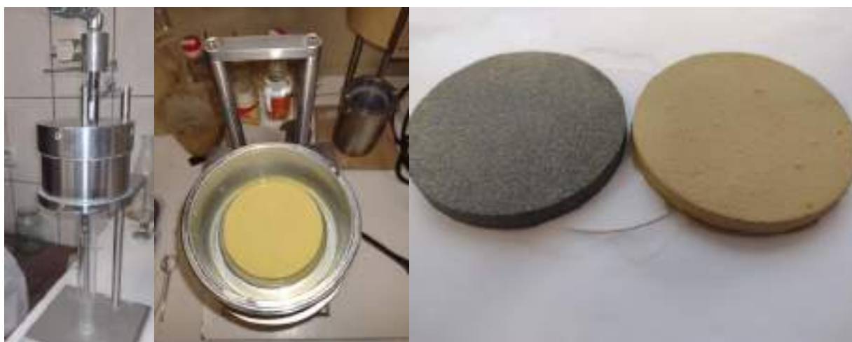
Рисунок 5 – фильтропресс высокого давления, керамические диски высокой проницаемости (слева направо)
