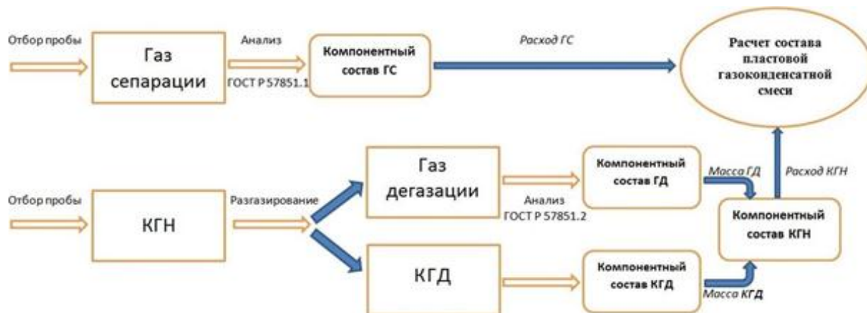
Рисунок 1 – Стандартная схема определения состава пластовой газоконденсатной смеси (пластового газа) с предварительным разгазированием нестабильного конденсата
