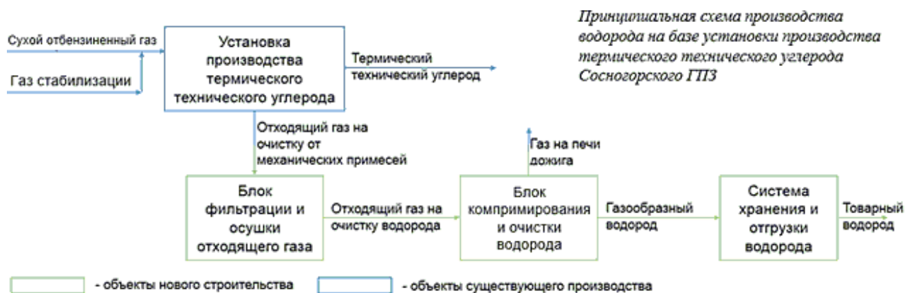
Рисунок 5 - Принципиальная схема производства водорода на базе установки производства термического технического углерода Сосногорского ГПЗ
