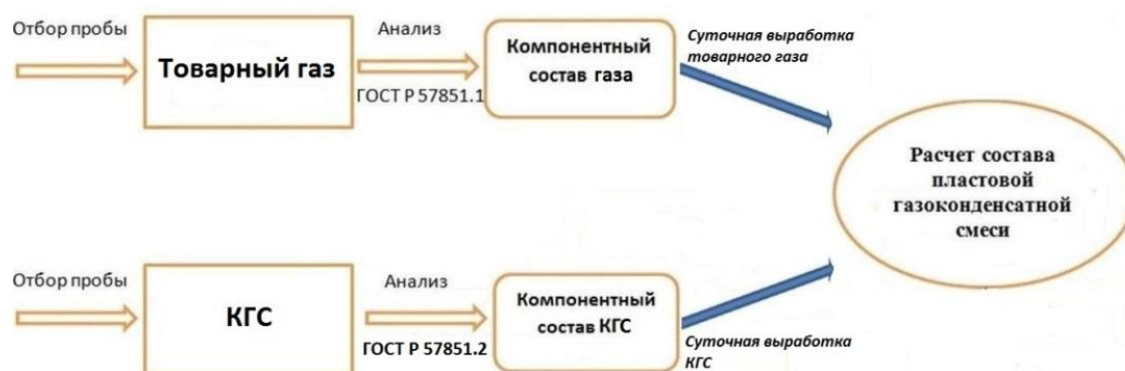
Рисунок 4 – Схема определения состава пластовой газоконденсатной смеси (пластового газа) на УКПГ, оснащенной установкой стабилизации конденсата
