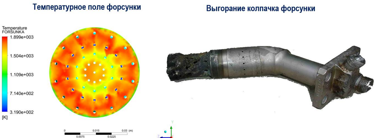
Рисунок 5 - Последствия приближения фронта пламени к торцам форсунок
