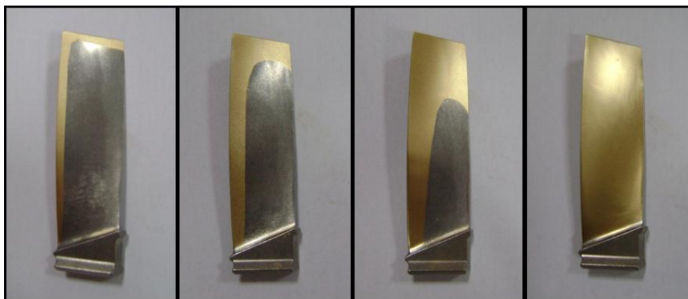
Рисунок 6 - Общий вид лопатки компрессора с четырьмя слоями последовательно напыляемого нитрид титанового покрытия, образующего функционально-ориентированное покрытие
