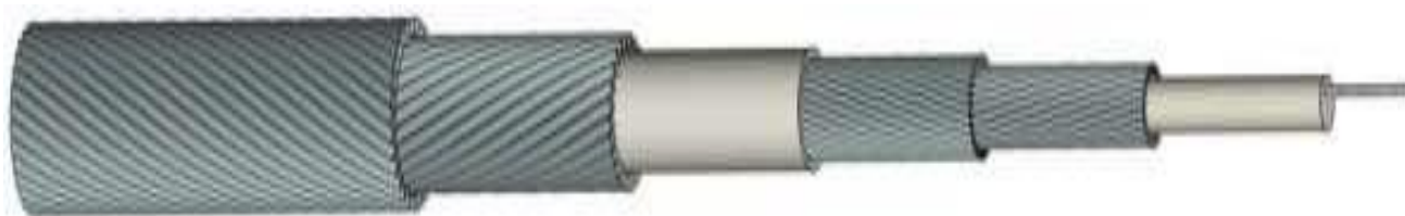
Рисунок 2 – Схема защитных покровов оптоволоконного кабеля
