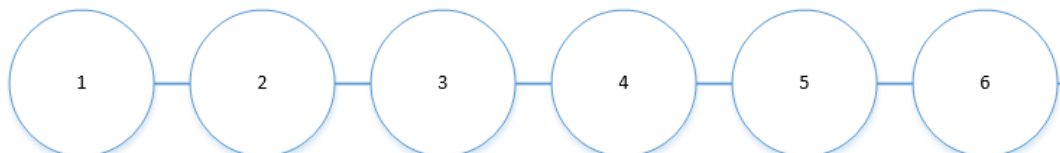
Рисунок 2 – Структурная схема надежности для центробежного насоса
