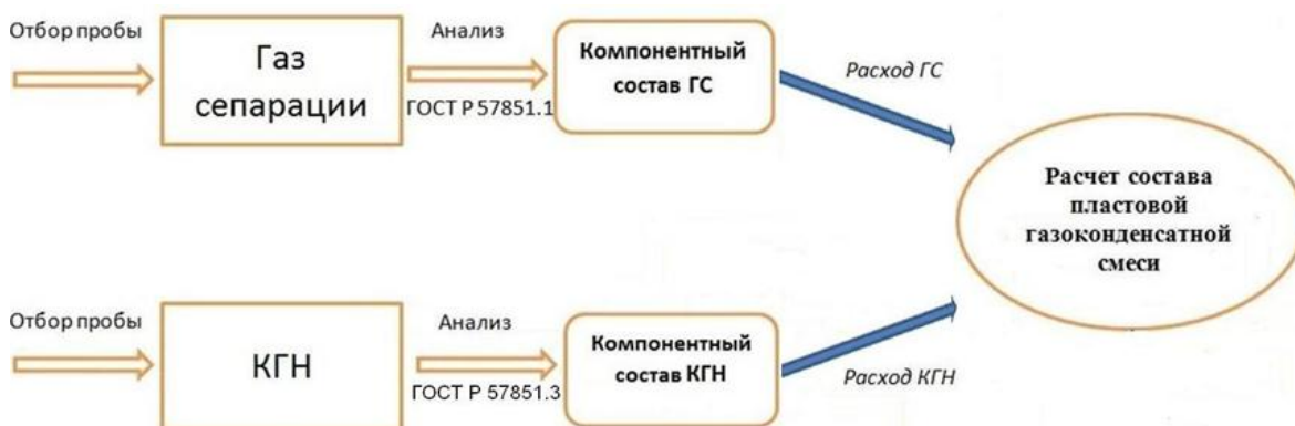
Рисунок 2 – Стандартная схема определения состава пластовой газоконденсатной смеси (пластового газа) без предварительного разгазирования нестабильного конденсата
