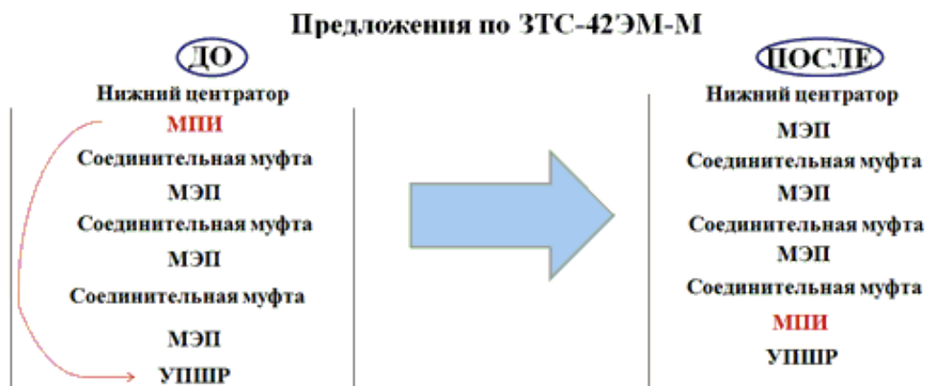
Рисунок 3 – Предложение по телесистеме ЗТС-42ЭМ-М
