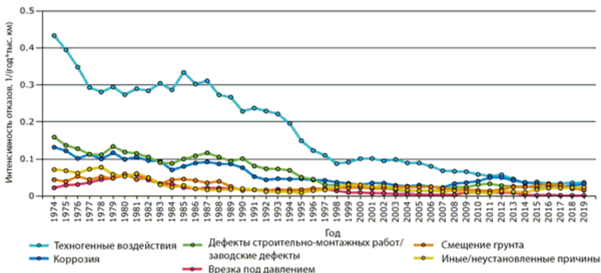
Рисунок 1 – Динамика значений скользящего среднего значения (за 5 лет) интенсивности аварий на трубопроводах по данным EGIG в период 1970-2019 гг.
