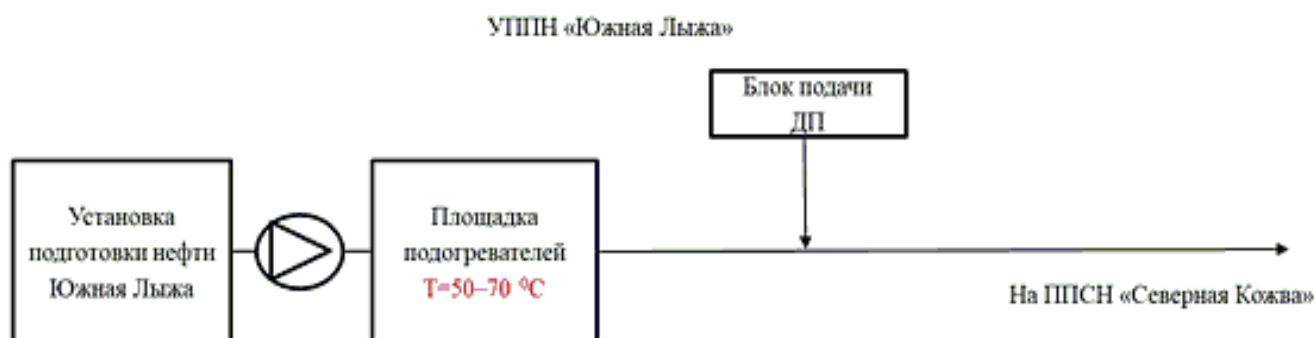
Рисунок 1 – Схема ввода химического реагента и нагрева нефти на УППН «Южная Лыжа» при её перекачке по межпромысловому нефтепроводу «Южная Лыжа – Северная Кожва»
