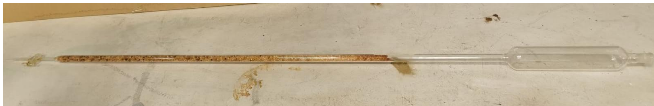
Рисунок 1 – Заполненная неокрашенным силикагелем колонка для анализа смолы переработки сланцев
