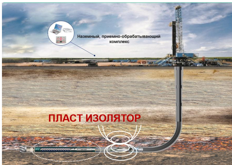
Рисунок 2 – Проблема затухания сигнала ЗТС
