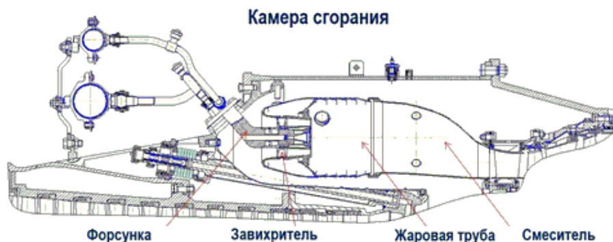
Рисунок 2 - Низкая надёжность элементов камеры сгорания ГТД ДГ90Л2.1
