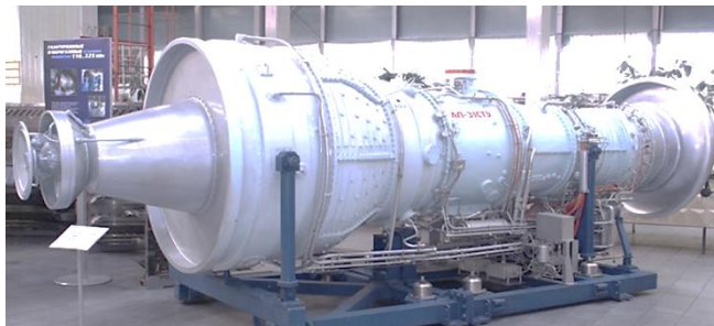
Рисунок турбины 8 – Модернизированный ru/posts/ газотурбинный система привод выхлопа АЛ-31СТ
