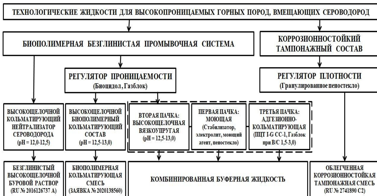
Рисунок 1 – Схема разработки рецептур технологических жидкостей
