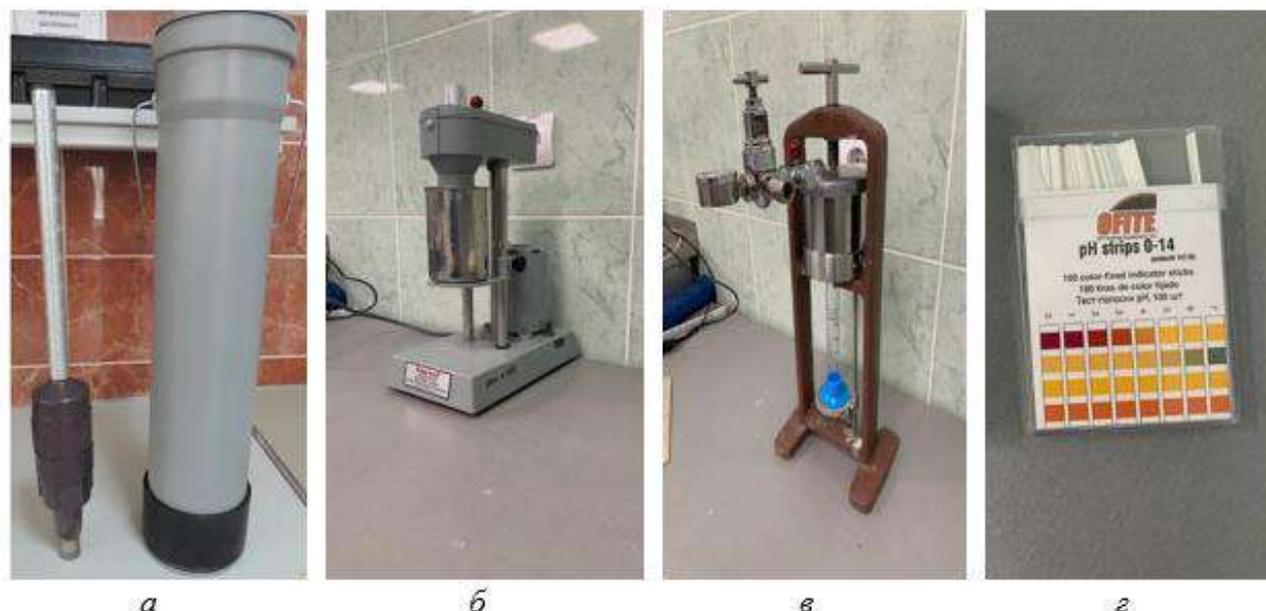
Рисунок 1 – Оборудование, используемое в исследовании: *а* - ареометр АБР-1, *б* - ротационный вискозиметр Fann 35 SA, *в* - фильтр-пресс низкого давления LPLT OFITE, *г* - рН-полоски фирмы OFITE
