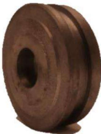
Рисунок 3.4. - Поршень гидроцилиндра Ц-100, восстановленный и упрочненный за счёт применения МДО с частицами нанопорошка CuO
