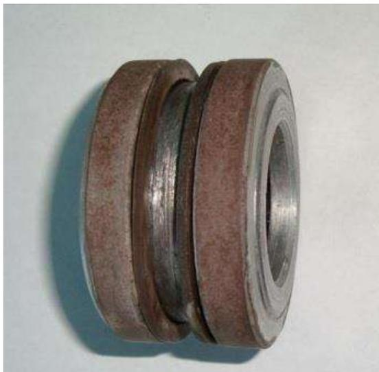
Рисунок 3.3. - Поршень гидроцилиндра Ц-75, восстановленный и упрочненный за счёт применения МДО с частицами нанопорошка CuO
