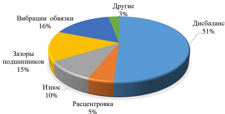
Рисунок 1 – Процентное соотношение возможных неисправностей МНА при повышенной вибрации
