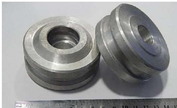
Рисунок 1.5. - Поршень гидроцилиндра Ц-75
