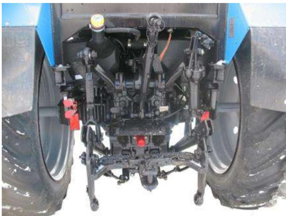
Рисунок 1.2. - Конструкция навесного оборудования
