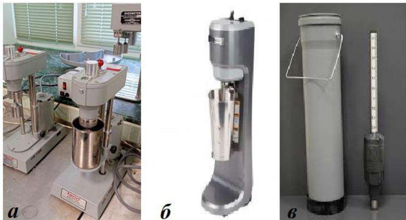
а) Вискозиметр Fann 35 SA, б) Мешалка 3-х скоростная, в) ареометр АБР-1
