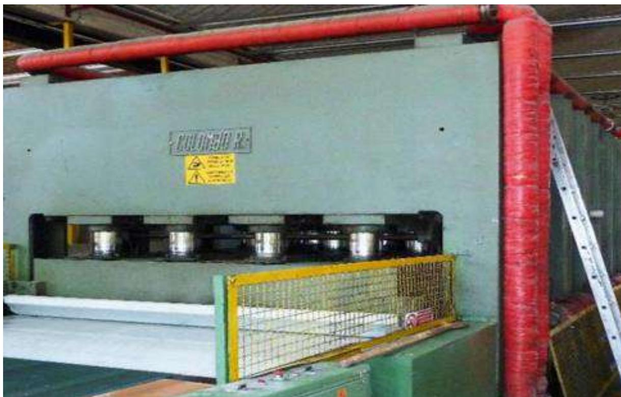
Рисунок 2 – Однопролетный пресс Б марки «PAGNONI»
