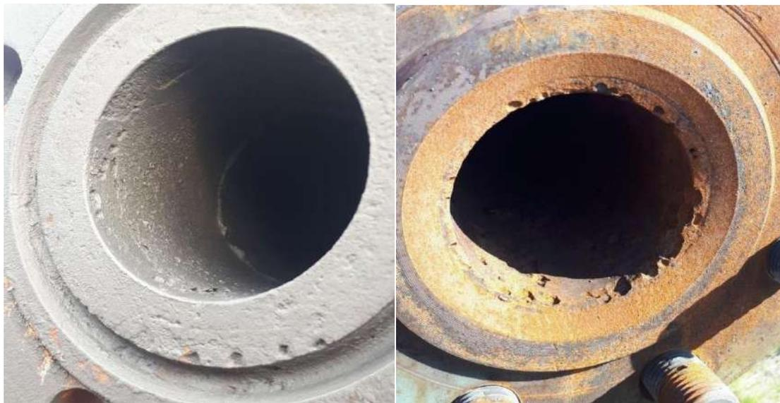
Рисунок 7 – Типовой внешний вид фланца перед задвижкой 4 в обвязке скважин, подверженный коррозионному износу
