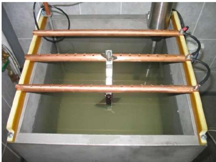
Рисунок 3.1. - Оборудование для микродугового оксидирования
