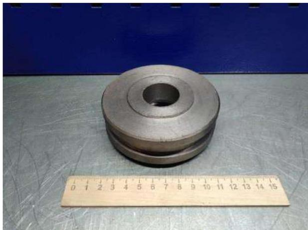
Рисунок 1.6. - Поршень гидроцилиндра Ц-100
