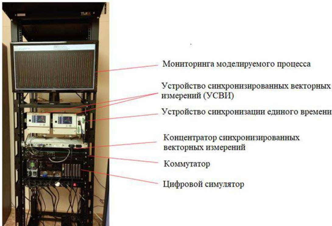
Рисунок 1 – Программно-аппаратный комплекс моделирования ЭЭС
