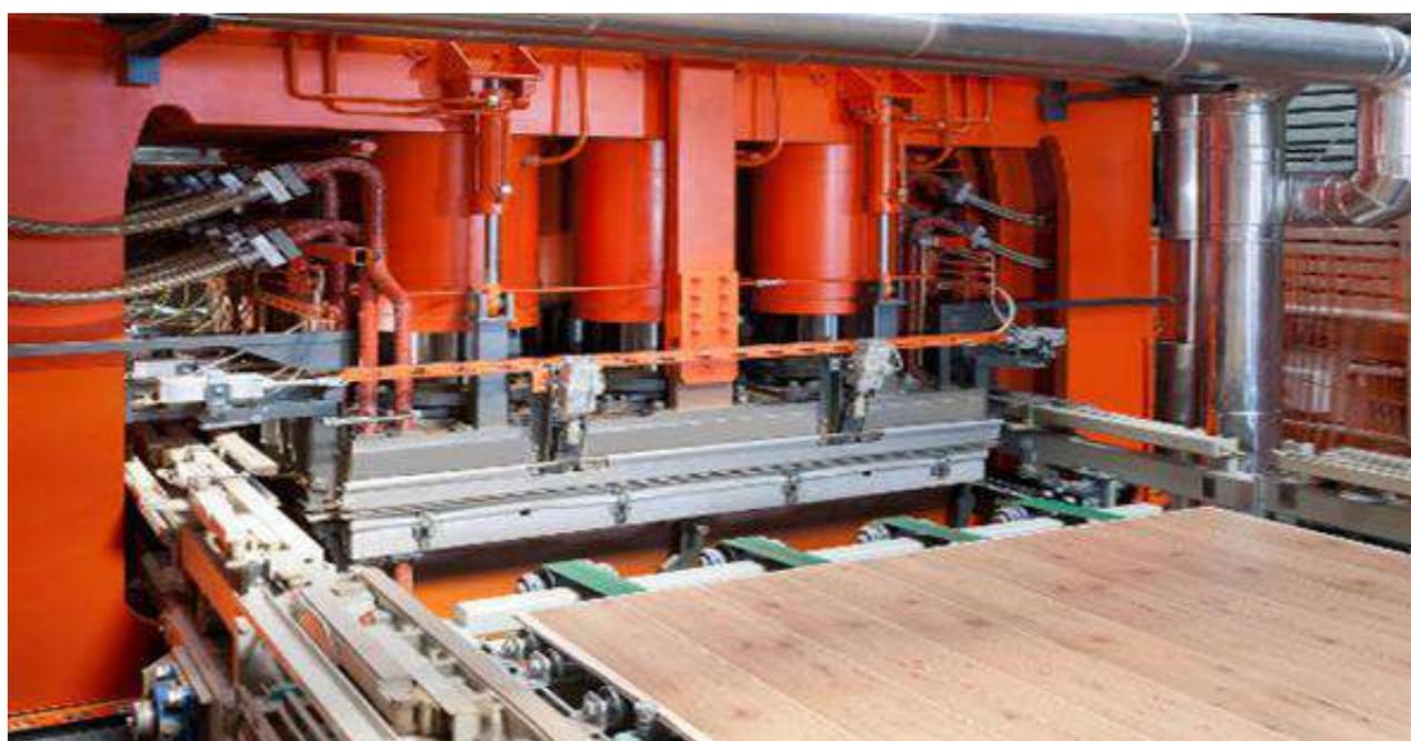
Рисунок 3 – Однопролетный пресс марки «WEMHÖNER»
