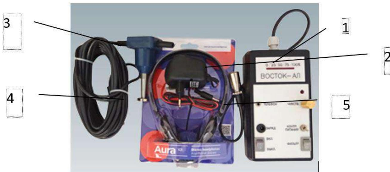
1-приемник; 2- головной телефон; 3- датчик с удлинителем кабелем; 4- магнитный держатель датчика; 5- шнур питания от бортовой сети автомобиля;
