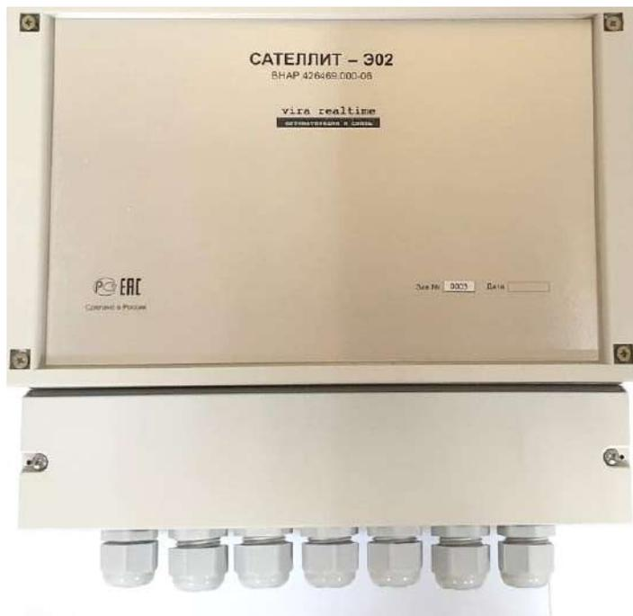
Рисунок 3 – Контроллер Сателлит-Э-02 производства ООО «НПА Вира Реалтайм»
