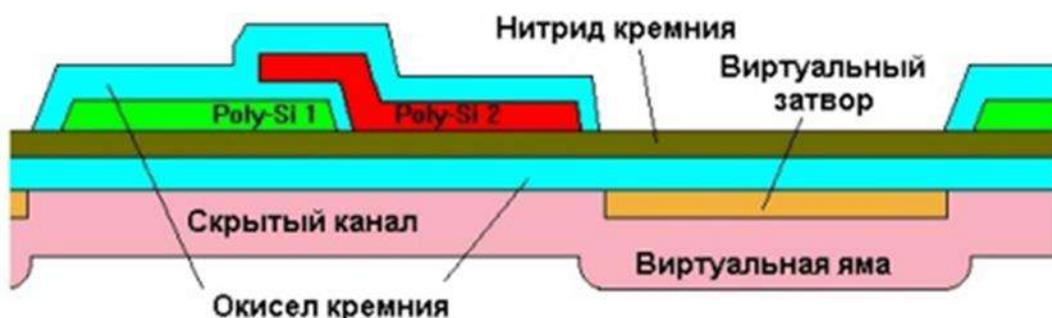
Рисунок 2 - ПЗС матрица с виртуальным затвором
