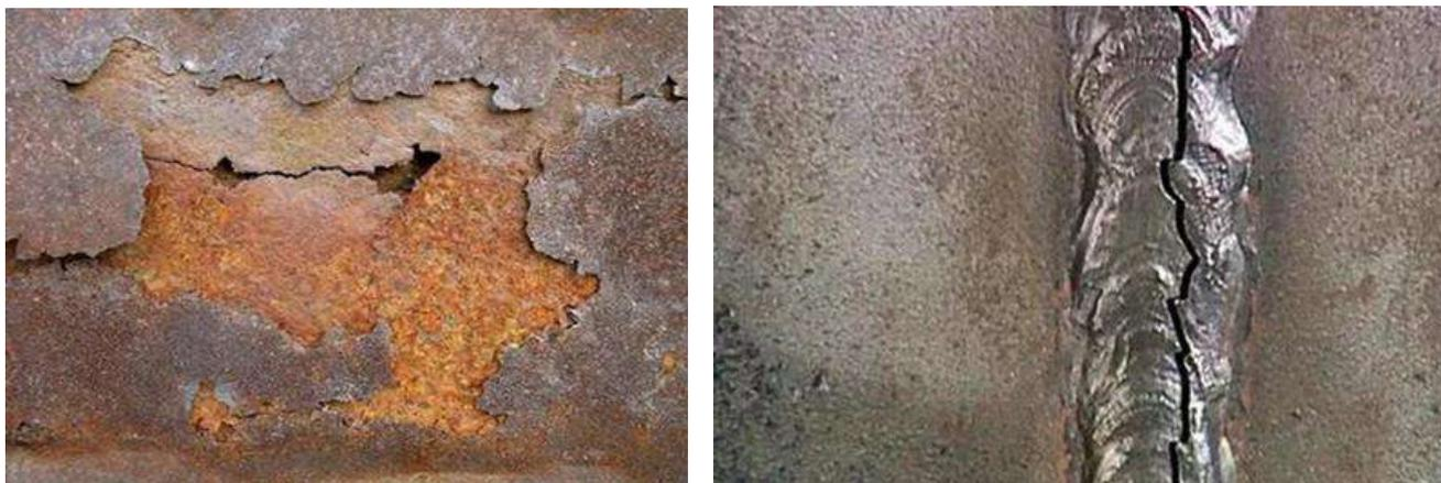
Рисунок 2 - Дефекты газовых сепараторов
