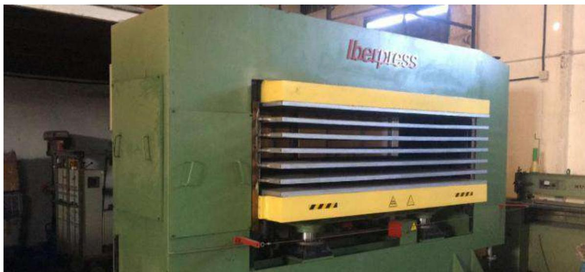
Рисунок 4 – Четырех пролетный пресс марки IBERPRESS [3]
