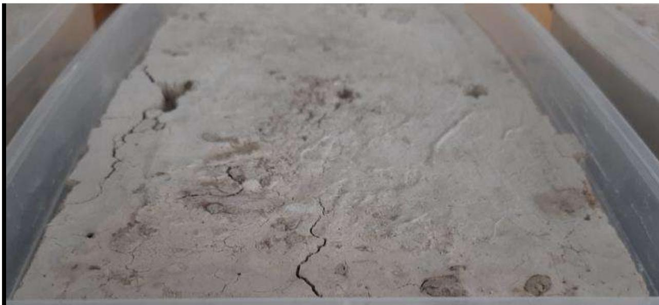
Рисунок 1 – Эксперимент по влиянию прогрева бетона на трещинообразование
