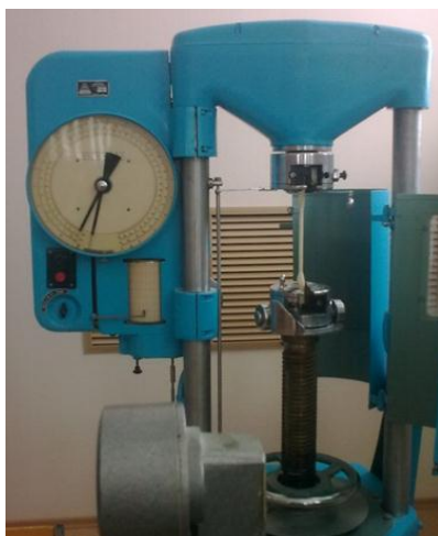
Рисунок 1 - Лабораторная установка для испытания на кручение «КМ-50-1»
