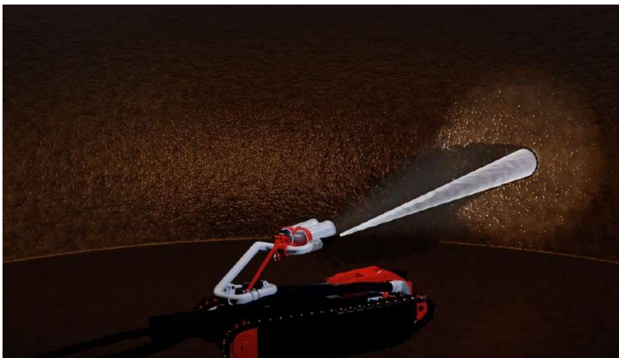
Рисунок 1 – Ввод в работу роботизированного чистильщика.
