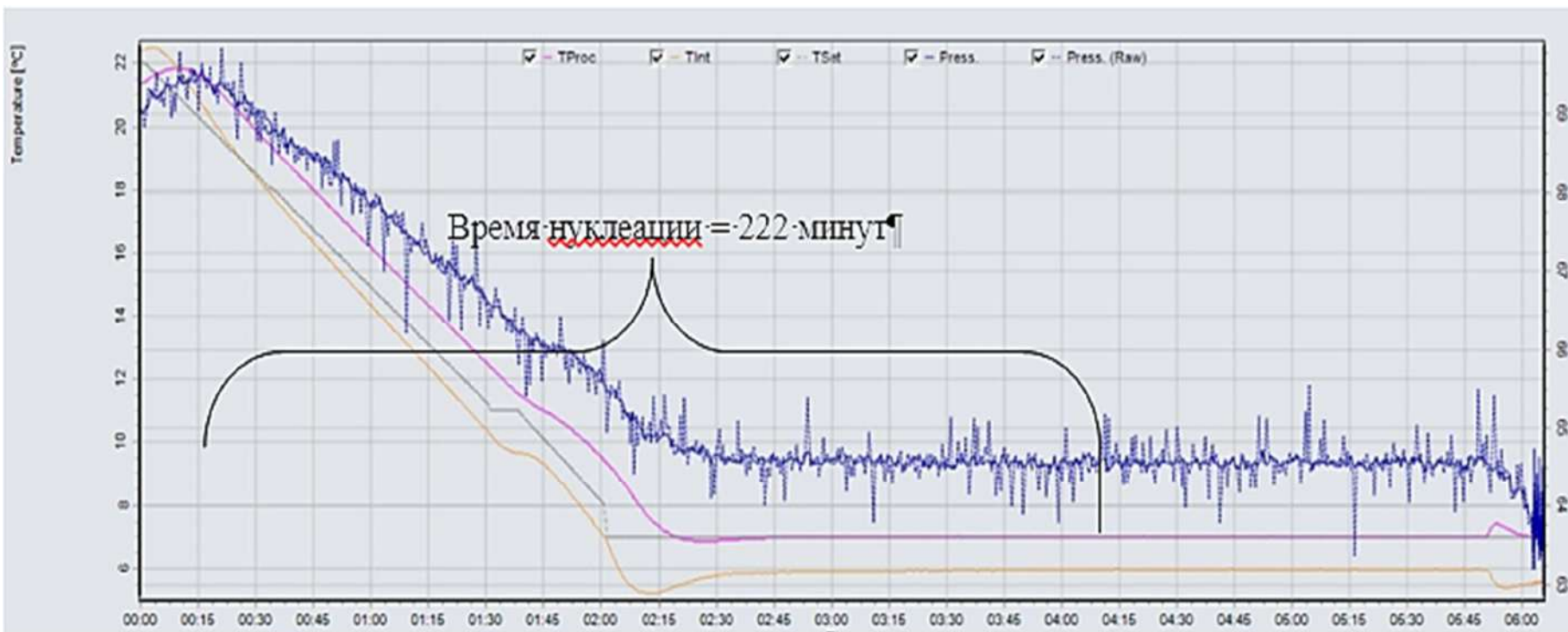
Рисунок 1 - Гидрат образовался через несколько часов после начала эксперимента [составлено авторами].
