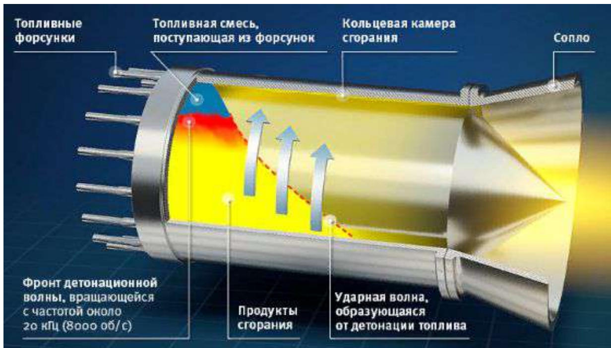
Рисунок 1 – Принцип действия детонационного ЖРД [6].
