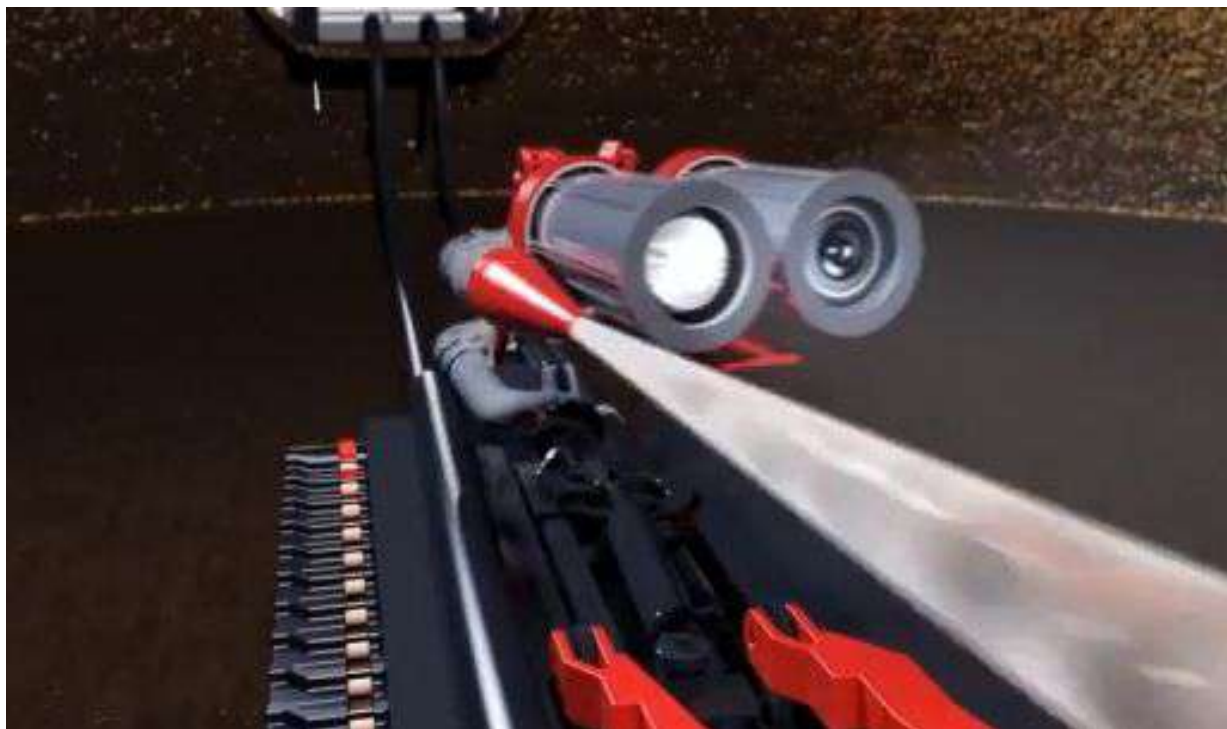
Рисунок 2 – Откачивающий насос и устройство для размыва отложений.
