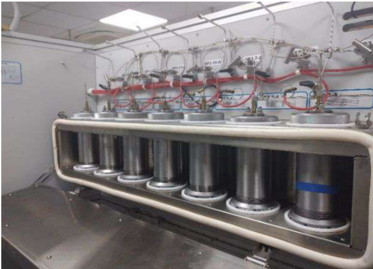
Рисунок 1 - Индивидуальные кернодержатели установки пластовой капилляриметрии, установленные в термоблоке.
