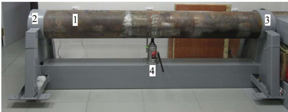
Рисунок 1 – Лабораторный стенд для исследования НДС стенки трубы при воздействии внешней радиальной нагрузки.
