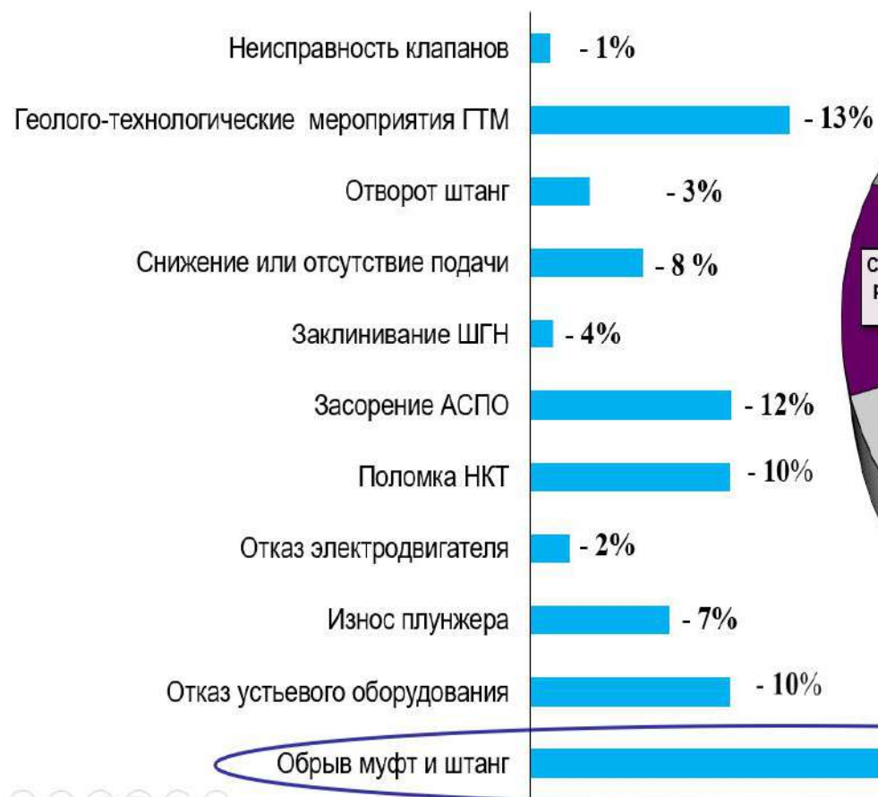
Рисунок 3 – Анализ проблем связанных с эксплуатацией скважинной штанговой насосной установки (СШНУ).
