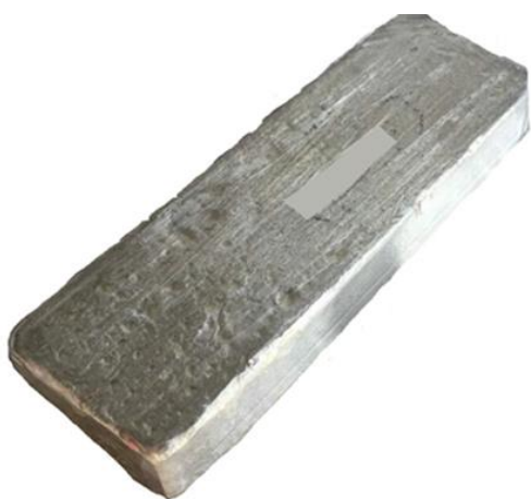
Рисунок 6 - Образец Fe до облучения.
