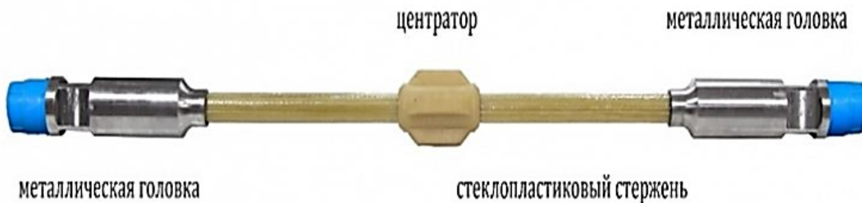
Рисунок 5 - Вариант крепления металлической высаженной части комбинированной штанги к её гладкой композитной части.
