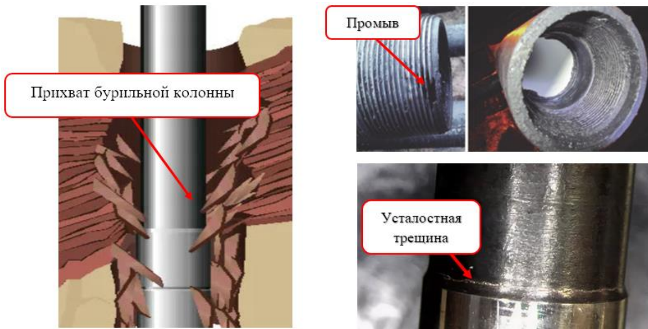
Рисунок 1 - На рисунке представлены частые технические причины, способствующие обрыву, слому бурильных труб при строительстве скважин. (Промыв ниппельного соединения и усталостная трещина по трубе).
