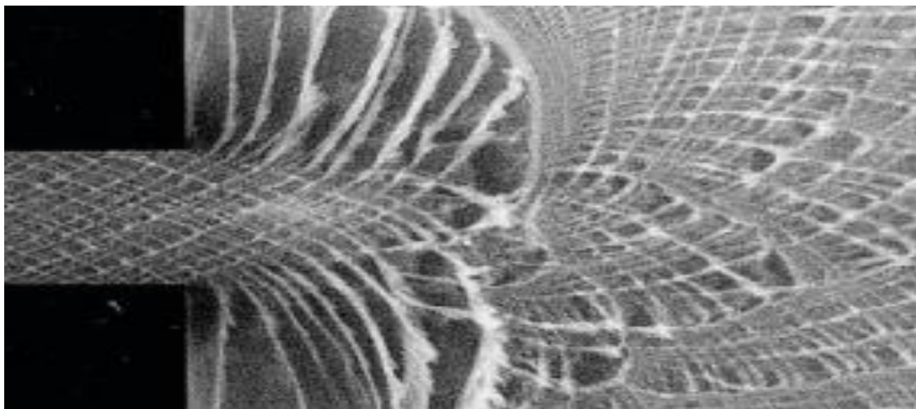
Рисунок 1 - Фото распространения ударных волн при переходе из узкого канала детонационной камеры в широкий канал забоя скважины [5].
