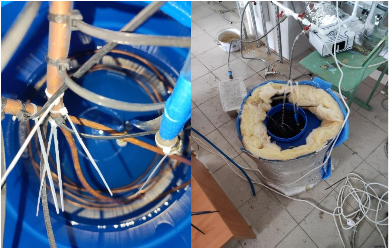
Рисунок 4 - Фото установки для сравнения аккумуляторов тепловой энергии ГВС с нагревательным элементом выполненным из различным материалов.
