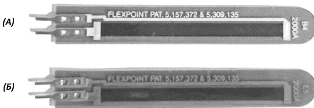
А – датчик изгиба из полиэстера, Б – полиимидный датчик изгиба
