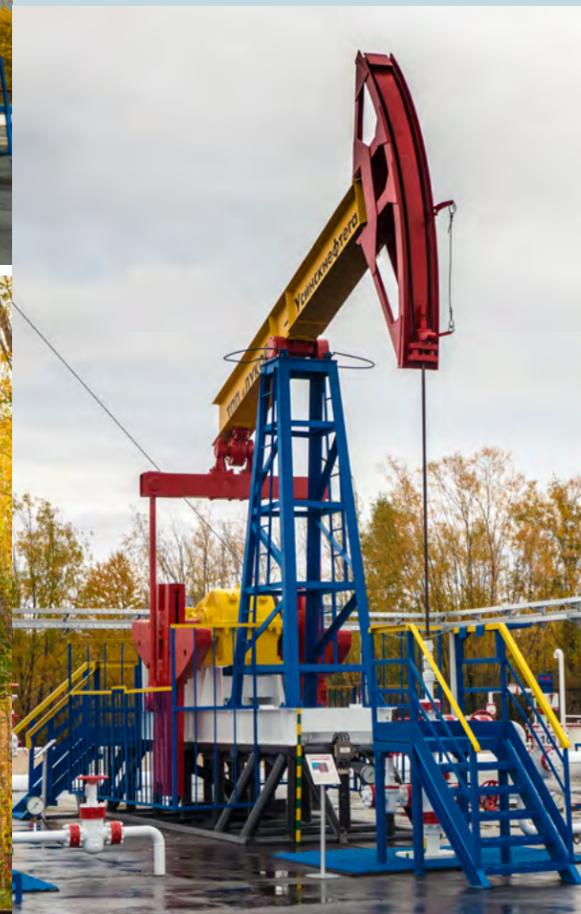
Скважина оборудованная штанговым глубинным насосом со станком качалкой СК8
