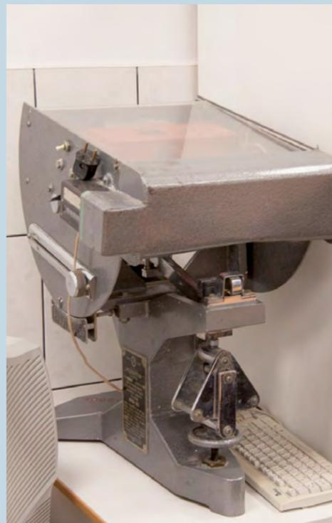
Испытательная машина для определения предела прочности цементов при изгибе МИИ-100
