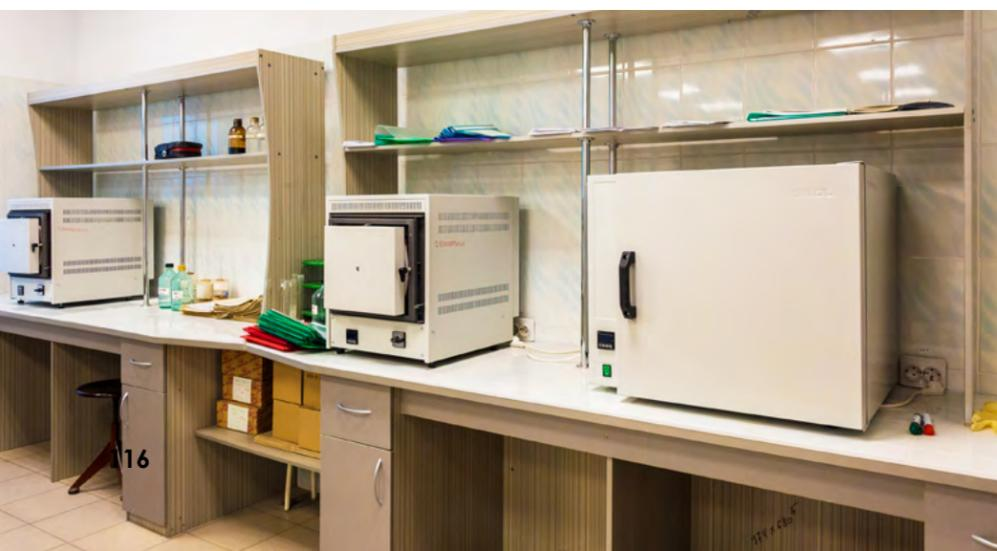
Лаборатория оборудована приборами для проведения аналитических работ в воздушной среде, нормализации и отпуска металла, пружин, термообработки пластмасс и других материалов в стационарных условиях.
