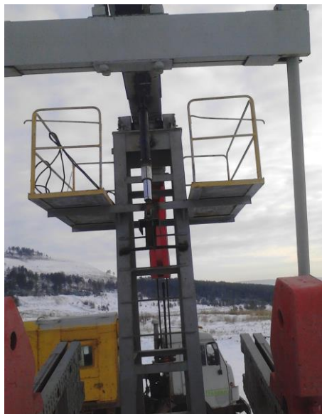
Рисунок 3 – Фотография станка – качалки с установленным маслозаполненным подвесным компрессором
