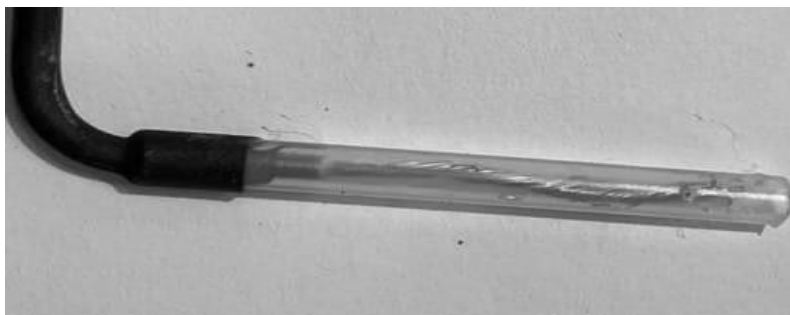
Рисунок 5 – Итоговая конструкция малогабаритного электрода сравнения (медный купорос отсутствует)
