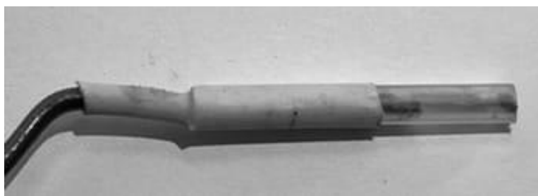
Рисунок 3 – Конструкция корпуса электрода без запирающей пробки
