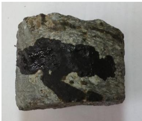
Рисунок 2 - Образец керна после паротепловой обработки
