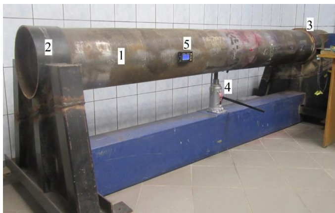
1 – труба; 2 – левая жёсткая опора; 3 – правая подвижная опора; 4 – гидравлический домкрат; 5 – инклинометр
