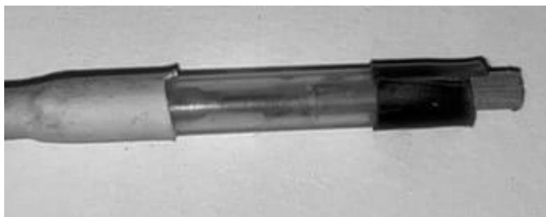
Рисунок 2 – Измененная конструкция электрода с дополнительной изоляцией пробки
