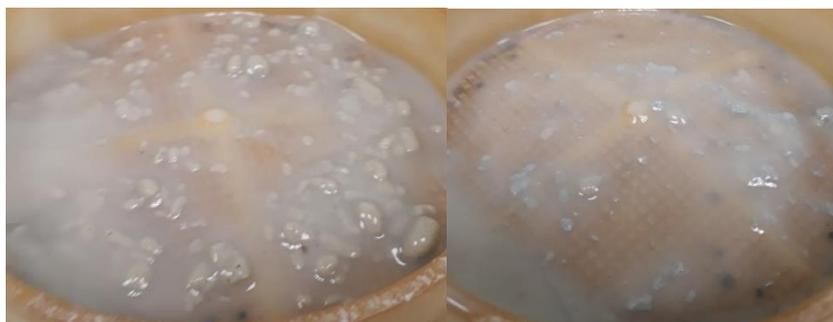
Рисунок 3 – Отфильтровавшиеся частицы на фильтре воронки Марша после прохождения раствора с не модифицированным асбестом, с 2 % КАЗ (слева направо)
