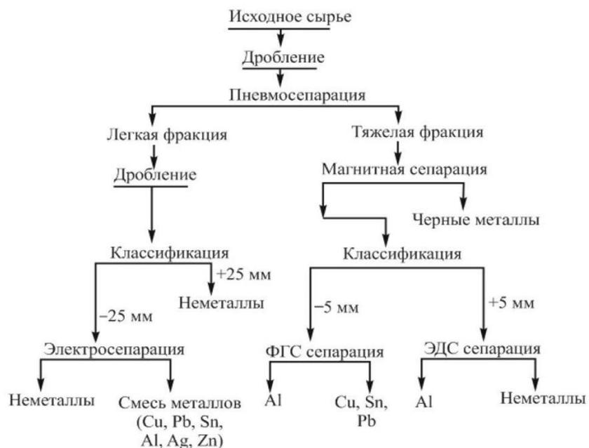
Рисунок 1 – Технологическая схема разделения многокомпонентного радиоэлектронного лома [1]
