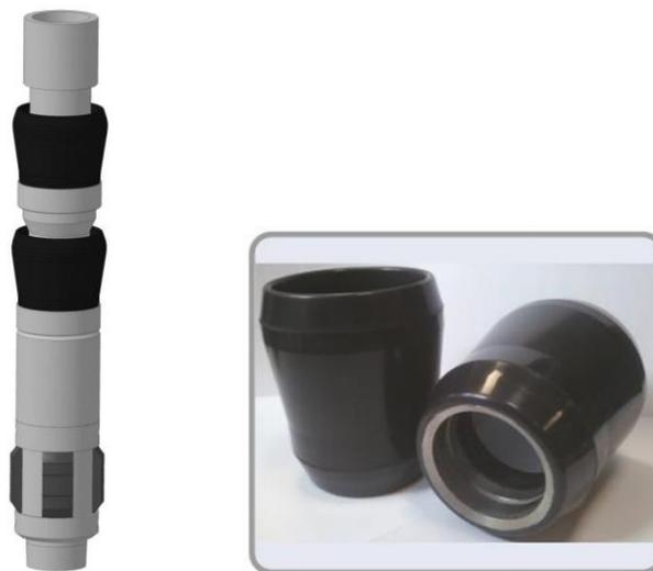
а) схема безъякорного пакерного устройства; б) уплотнительные манжеты безъякорного пакерного устройства
