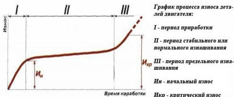
Рисунок 6 – График процесса износа деталей двигателей.
