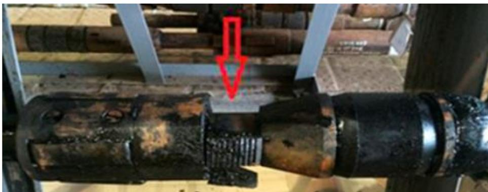
Рисунок 1 – Слом плашек якорного узла в пакерном устройстве
