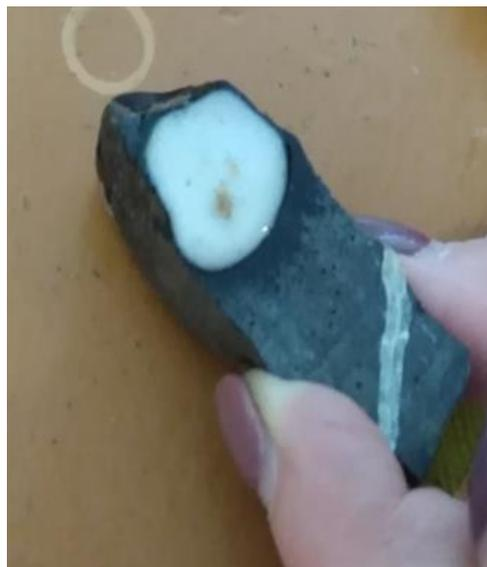
Рисунок 6 - Результат реакции с соляной кислотой
