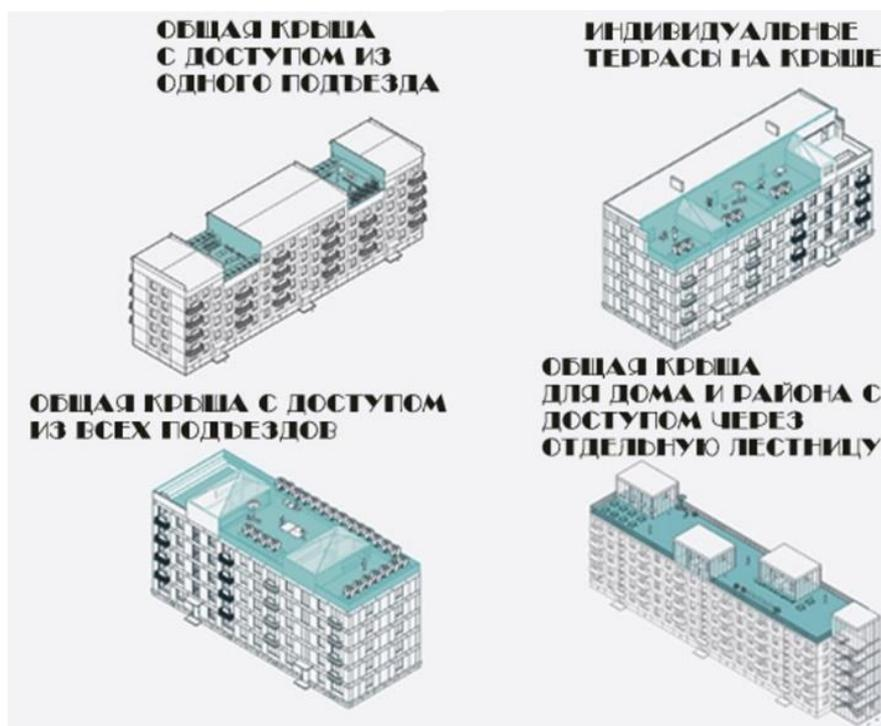
Рисунок 3 – Приемы реконструкции и использования последних этажей и покрытий домов
