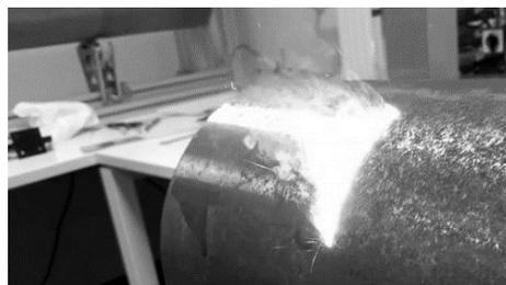
Рисунок 13 - Наглядное изображение лазерной очистки труб
