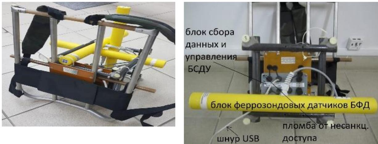
Рисунок 5 - Дистанционной диагностики прибор КБД-2
