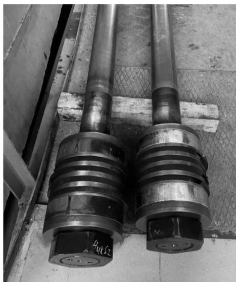
Рисунок 3 – Поршни современного типа, используемые на ГМК и ГКН
