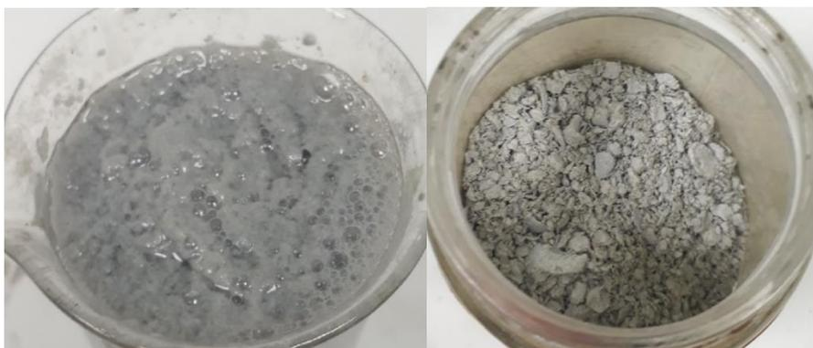
Рисунок 1 – Асбестовая крошка - не модифицированный асбест, КАЗ – модифицированный асбест (слева направо)
