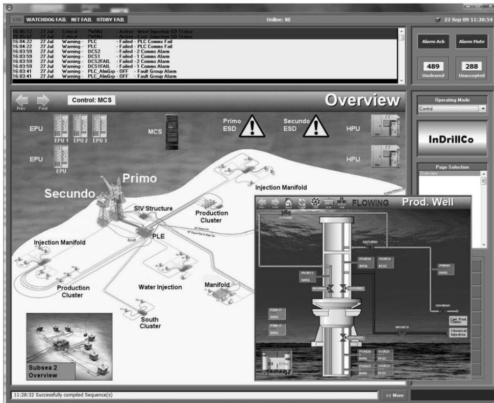
Рисунок 3 – Вывод схемы подводного промысла через систему SCADA
