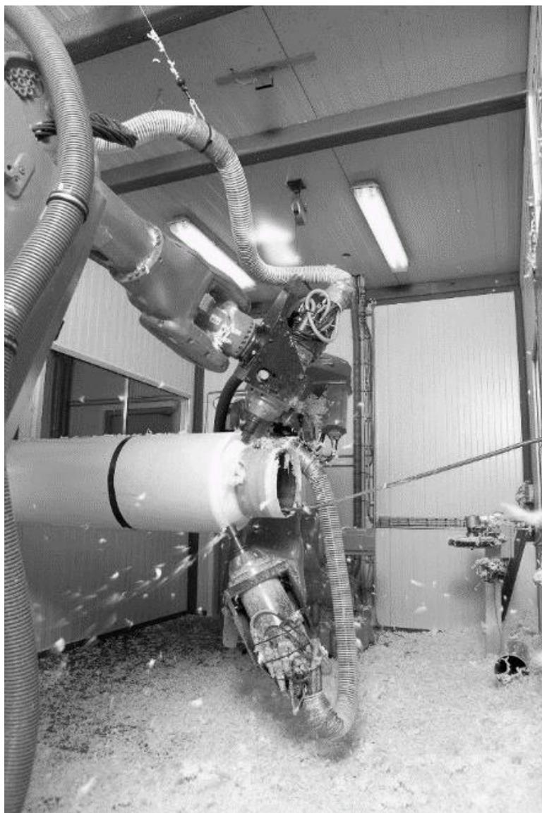
Рисунок 1 - Роботизированная зачистка – фрезерование
