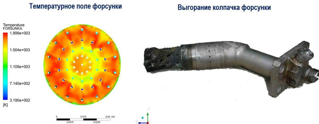
Рисунок 5 - Последствия приближения фронта пламени к торцам форсунок.
