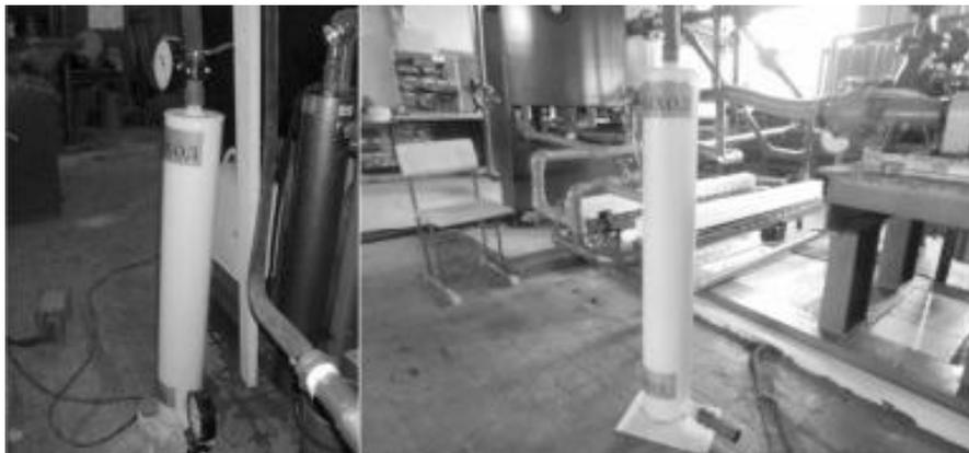
Рисунок 2 - Внешний вид индукционного нагрева жидких сред
