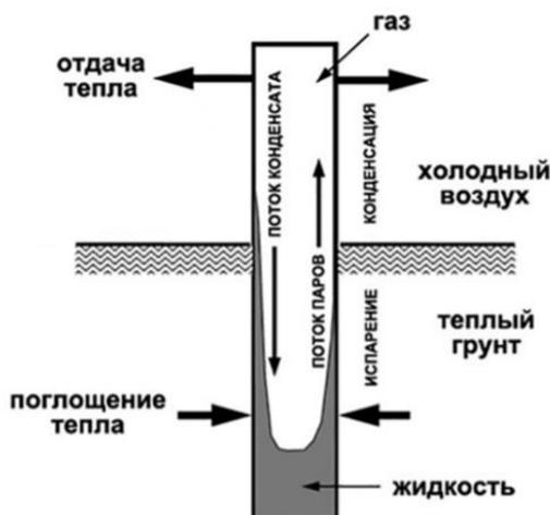
Рисунок 1 – Схема работы термостабилизатора
