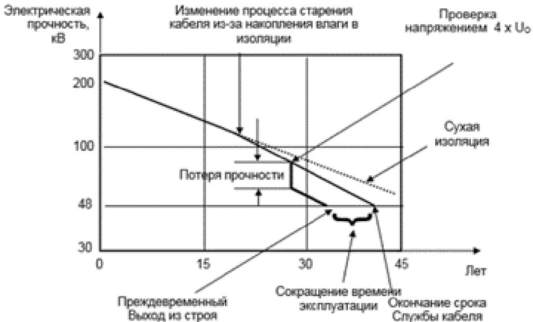
Рисунок 1 - Диаграмма срока службы кабеля и влияния на него испытательного напряжения  $4 \times U_0$  на примере кабеля 20 кВ.
