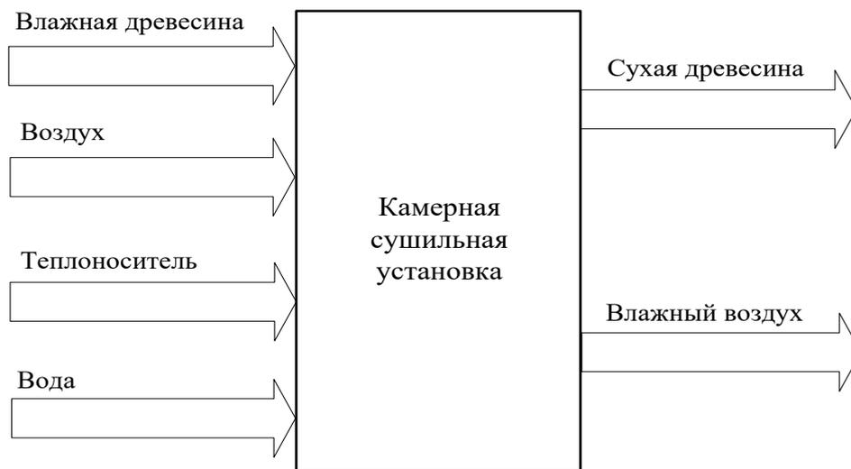
Рисунок 2 – Схема материальных потоков камерной сушильной установки
