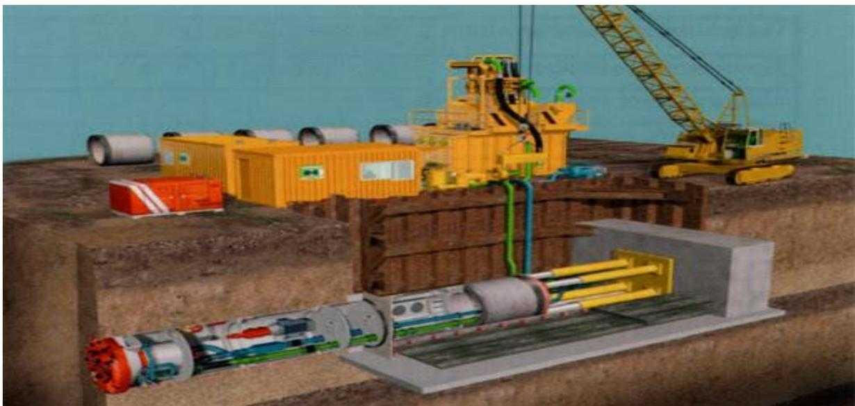
Рисунок 2 - Метод микротоннелирования
