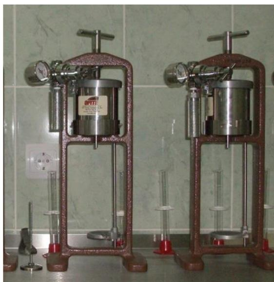
Рисунок 2 – фильтропресс высокого давления
