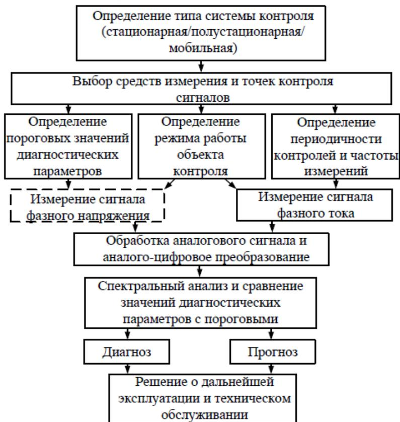
Рисунок 2 – Последовательность операций электропараметрического метода диагностики
