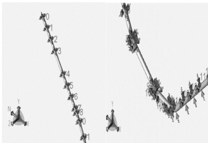
Рисунок 2 - Моделирование рабочего состояния трубопровода после засыпки [3]
