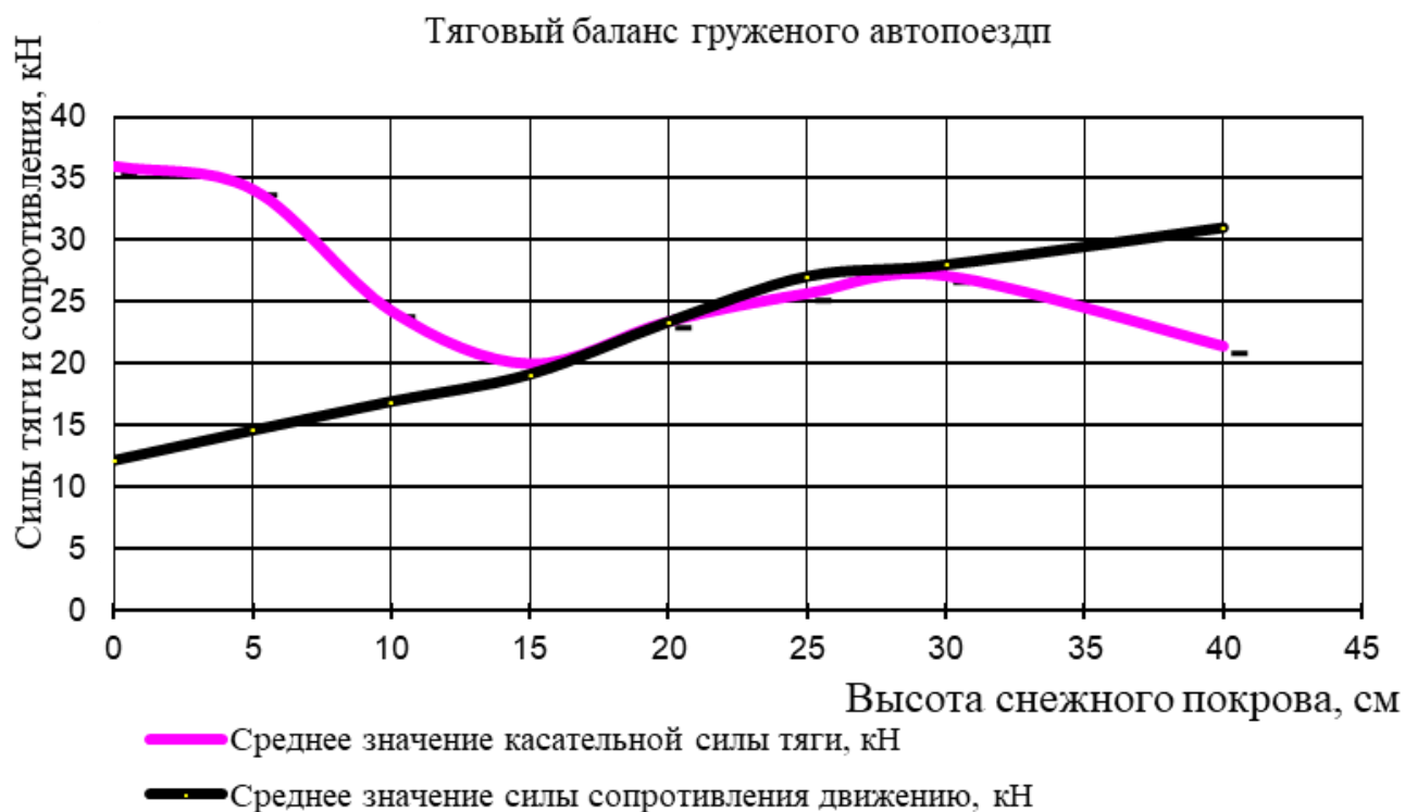
Рисунок 5 - Изменения сил сопротивления движения и касательной силы тяги автопоезда Урал 4320 с нагрузкой 87,9 кН в зависимости от высоты снежного покрова на проезжей части при однократном проходе
