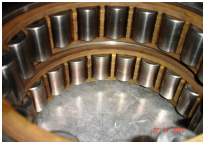
Рисунок 3 – Медное (серповитное) покрытие на поверхностях трения, образовавшаяся из смазочного материала
