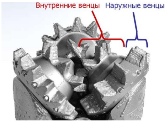
Рисунок 2.2– Внутренние и внешние венцы шарошек
