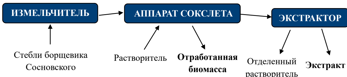
Рисунок 2 – Блок-схема получения маркерных соединений
