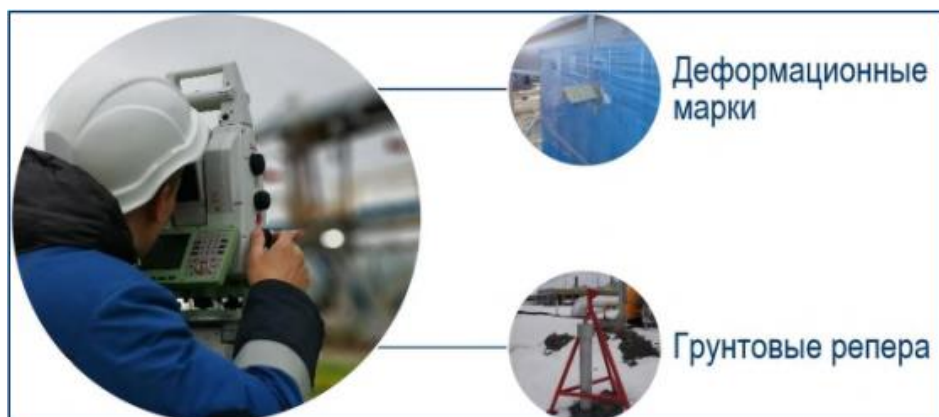
Рис. 1 – Геодезический контроль в рамках выполнения работ по ГТМ
