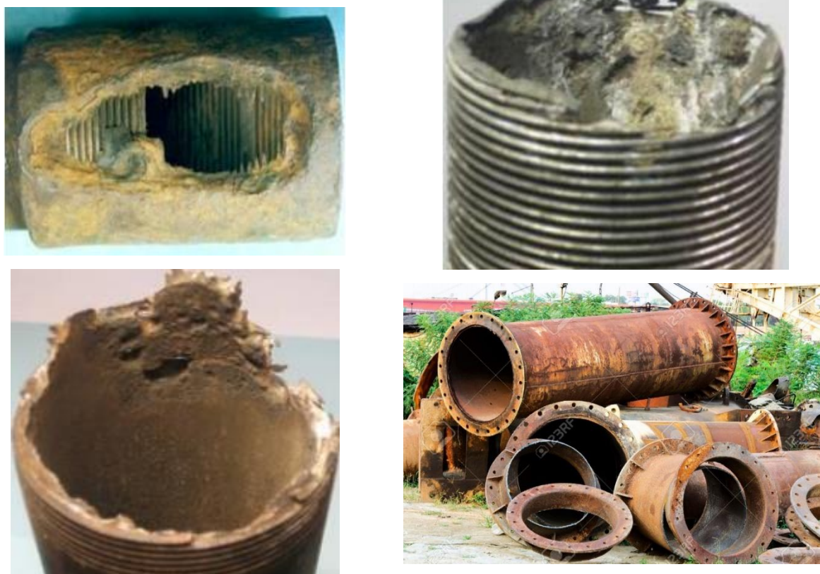
Рисунок 1 – Коррозионные дефекты нефтегазового оборудования
