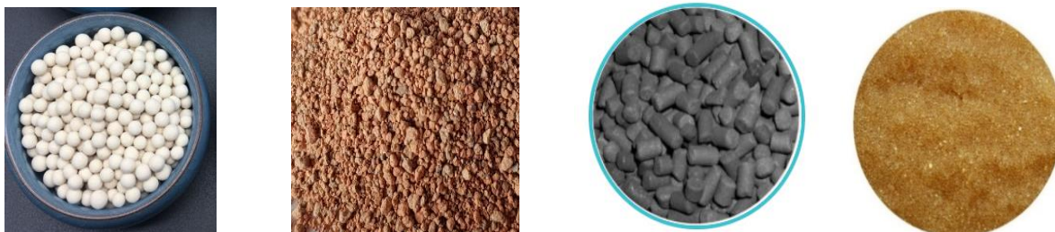
а) alkene адсорбент, б) сорбент полсорб, в) активированный уголь, г) ионообменная смола
