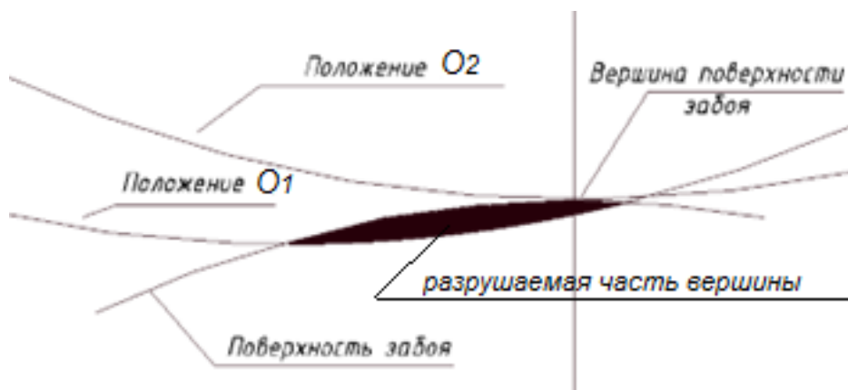
Рисунок 8. Механизм разрушения вершины забоя
