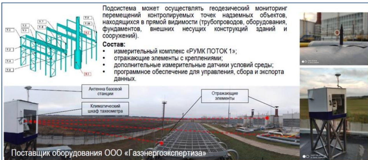
Рис. 7 - Подсистема измерения координат РУМК «ПОТОК 1»
